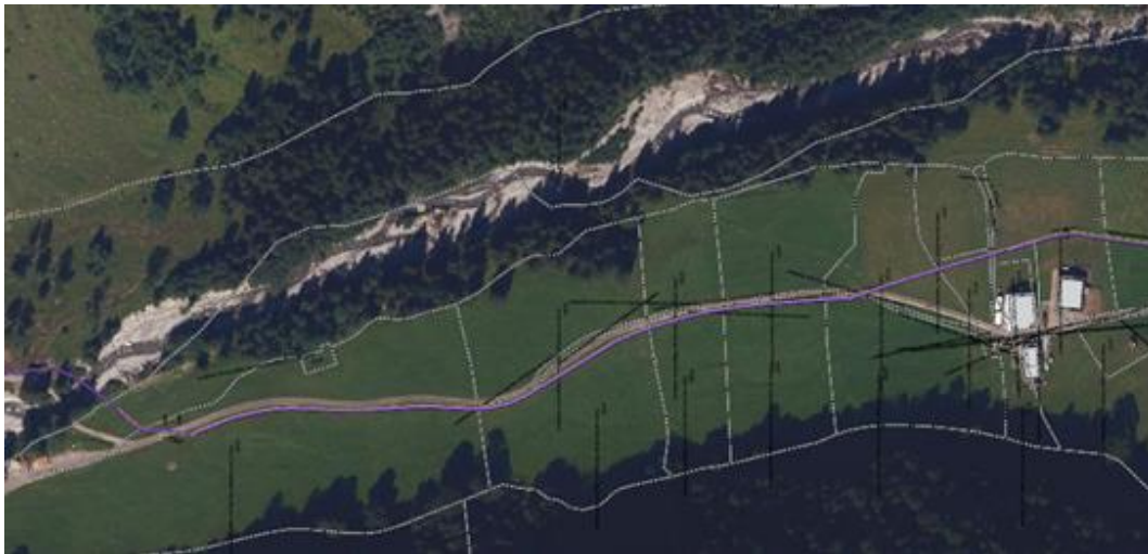
Abb. 17: Luftbildausschnitt mit Trasse Abwasserleitung und 20 kV-Stromleitung
