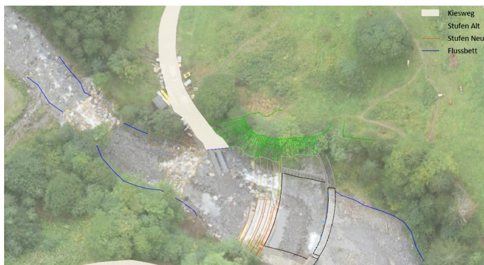
Abb. 14: Vermessung Sperre mit Sohl-sicherungsmaßnahmen des WWA Kempten (Quelle Firma Geiger Aufnahme: 18.09.2023 & 28.09.2023)
