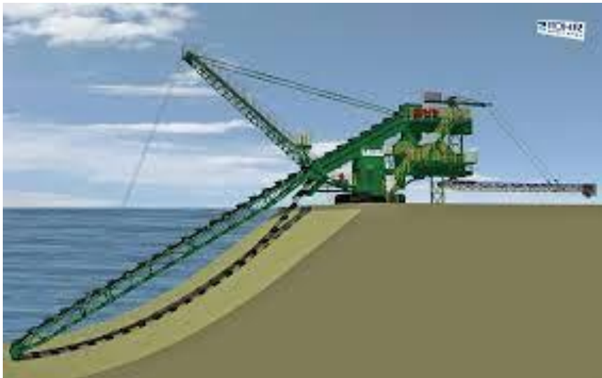
Abbildung 5-1: Prinzipdarstellung Nassgewinnung mittels landgestützten Eimerkettenbaggers
