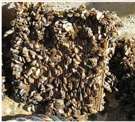
Abb. 6: Muschelbefall an Filterelementen und Rohrleitungen
