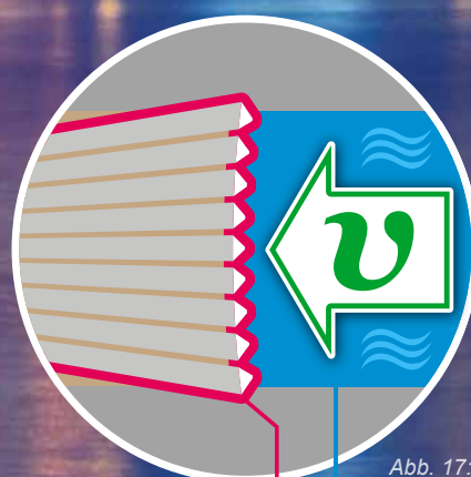
Abb. 17: Hohe Rückspülgeschwindigkeiten bei kleinen Filterflächen
