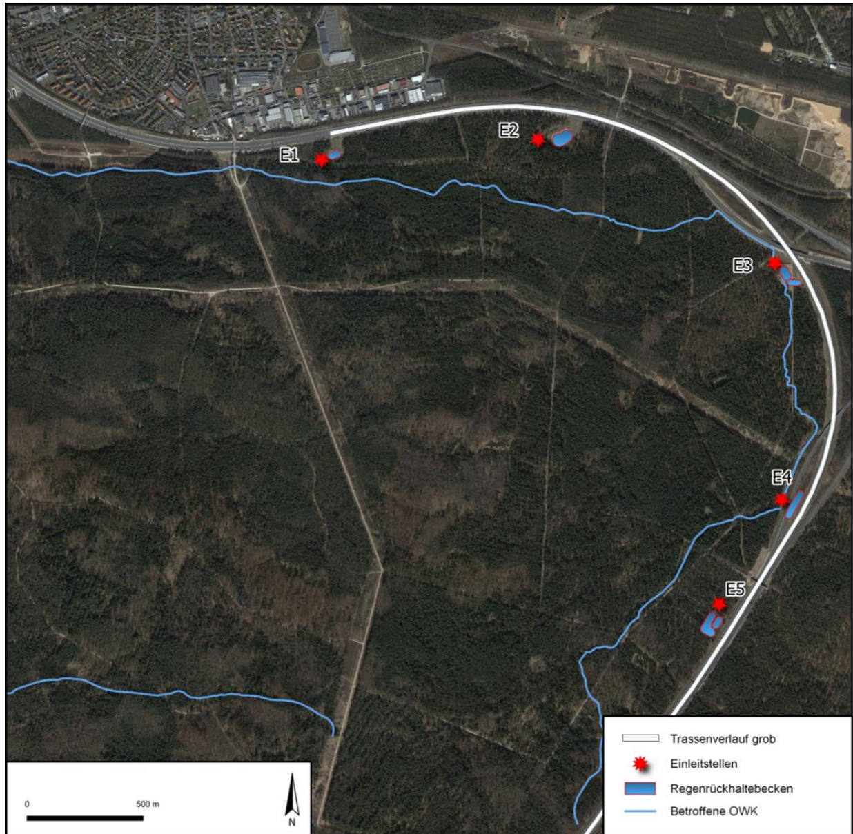
Abbildung 7: Lage der Entwässerungsanlagen und Einleitstellen sowie grobe Trassenlage (nördlicher Abschnitt)
