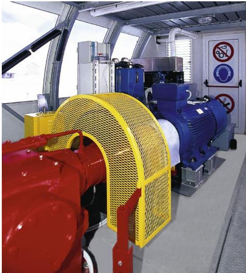
Antriebseinheit: E-Motor, Betriebsbremse, Getriebe (Beispiel)
