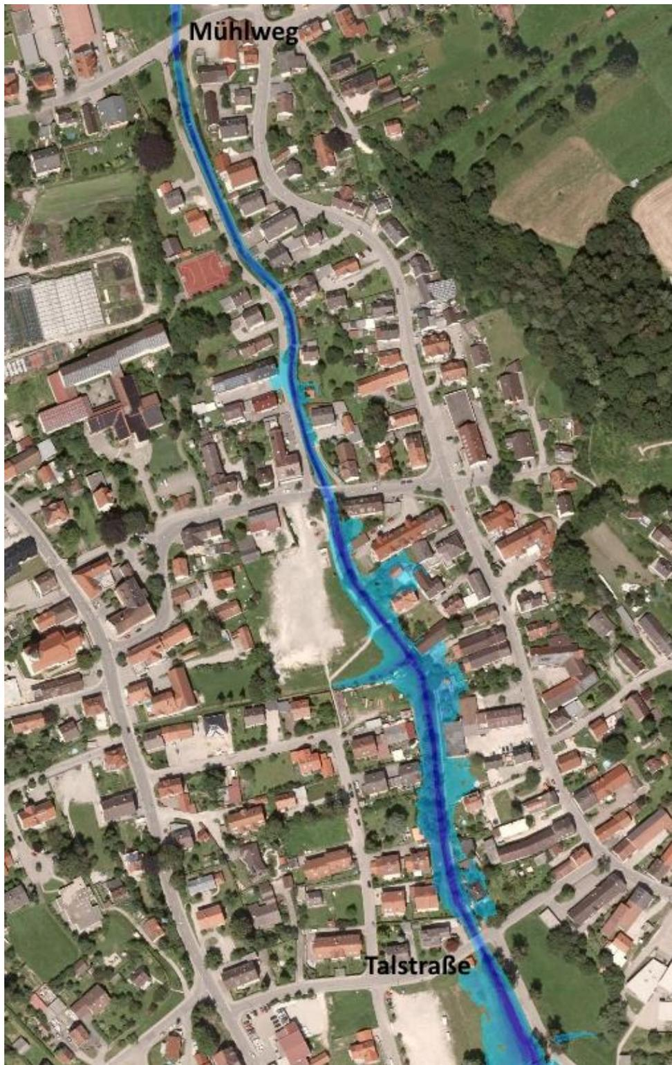
**Abbildung 12: Überschwemmungssituation im nördlichen Siedlungsgebiet von Welden bei einem Drosselabfluss von  $Q = 6,5 \text{ m}^3/\text{s}$  vor der Ortslage und innerörtlichen (z.T. über bestehende Rückhaltungen gedrosselten) HQ100-Zuflüssen.**
