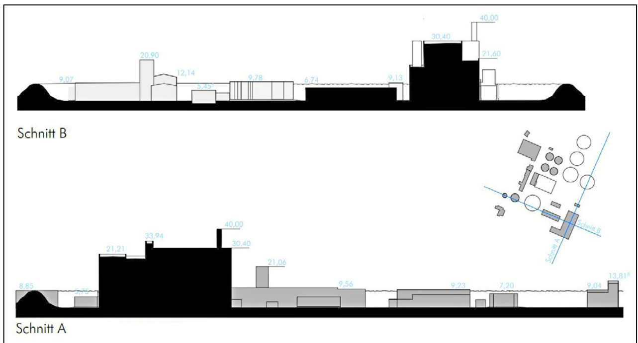
Abbildung 7: Schematische Schnitte der KVA innerhalb des Kläranlagengeländes zur Verdeutlichung der Gebäudedimensionierung
