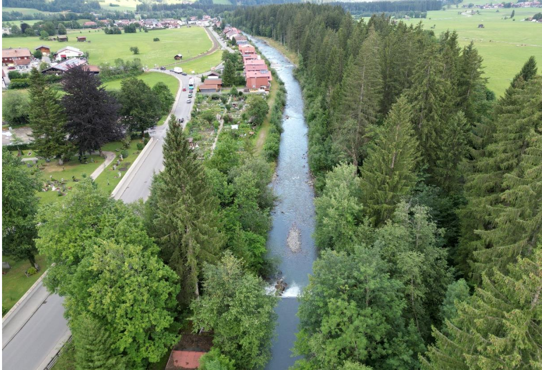
Abbildung 11: Begradigter, kanalartiger Abflussquerschnitt mit nur einseitig gut ausgeprägter Ufervegetation (ITS Scheiber ZT GmbH, 2023)
