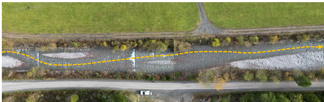
Abbildung 30: Versuchsstrecke mit Wanderkorridor in der geplanten Restwasserstrecke der Trettach (ITS Scheiber ZT GmbH, 2024)
