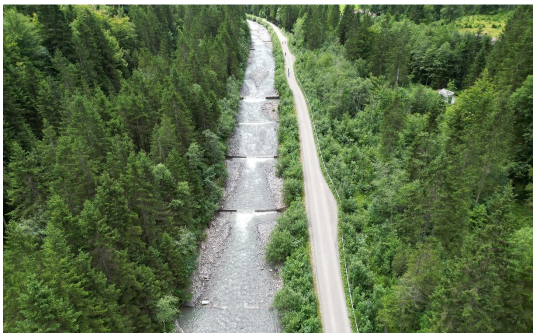
Abbildung 5: Verbauter und begradigter Abschnitt der Trettach mit zahlreichen Absturzbauwerken (ITS Scheiber ZT GmbH, 2023)
