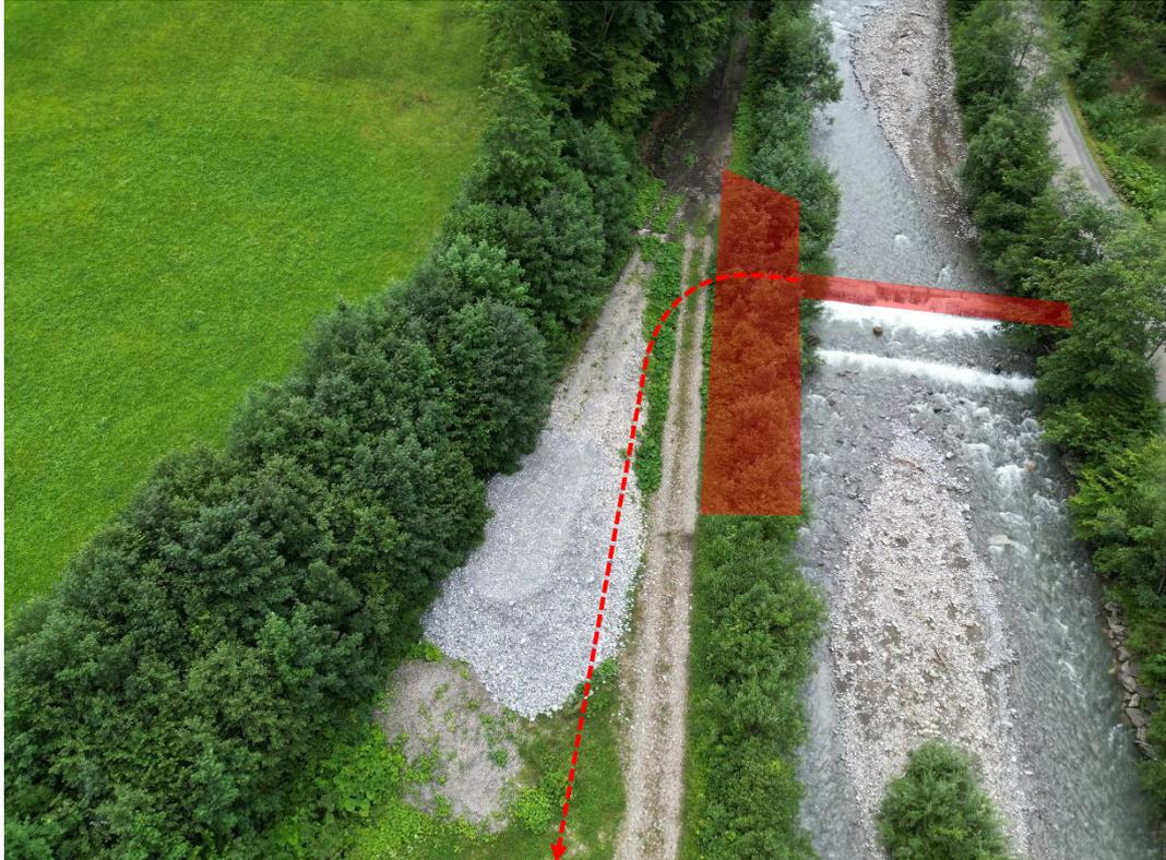
Abbildung 4: Geplante Lage der Wasserentnahme im Bereich des bestehenden Absturzbauwerks (ITS Scheiber ZT GmbH, 2023)
