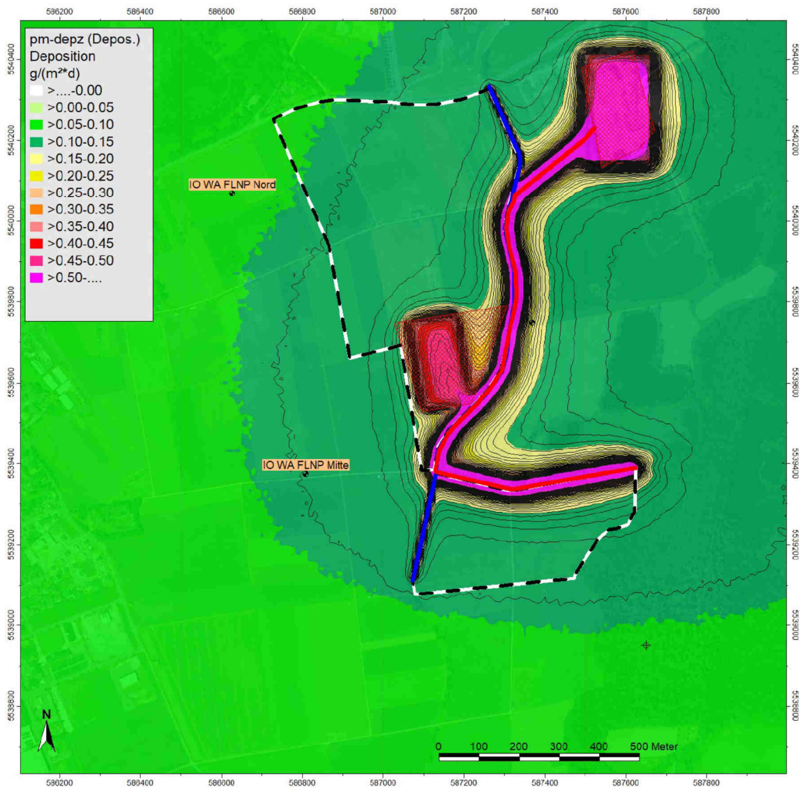
Abb. 3: Die Abbildung zeigt die Immissionsgesamtbelastung der Staubdeposition im Jahresmittel in g/m 2 ·d, die Werte sind aus der Sicht des Immissionsschutzes unkritisch (Quelle: Wölfel Engineering GmbH + Co. KG).
