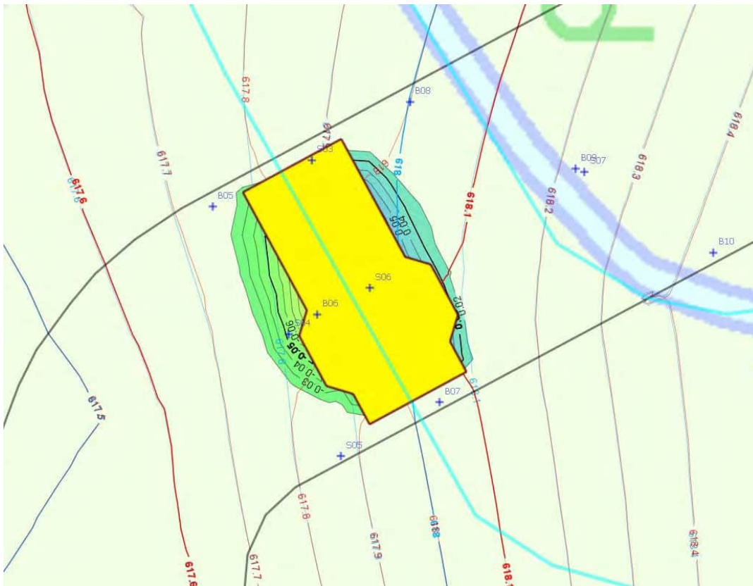
Abbildung 49: Spundwandverbau am Auslassbauwerk; Differenzhöhen der Grundwasserstände (rechts Aufstau, links Absenkung)
