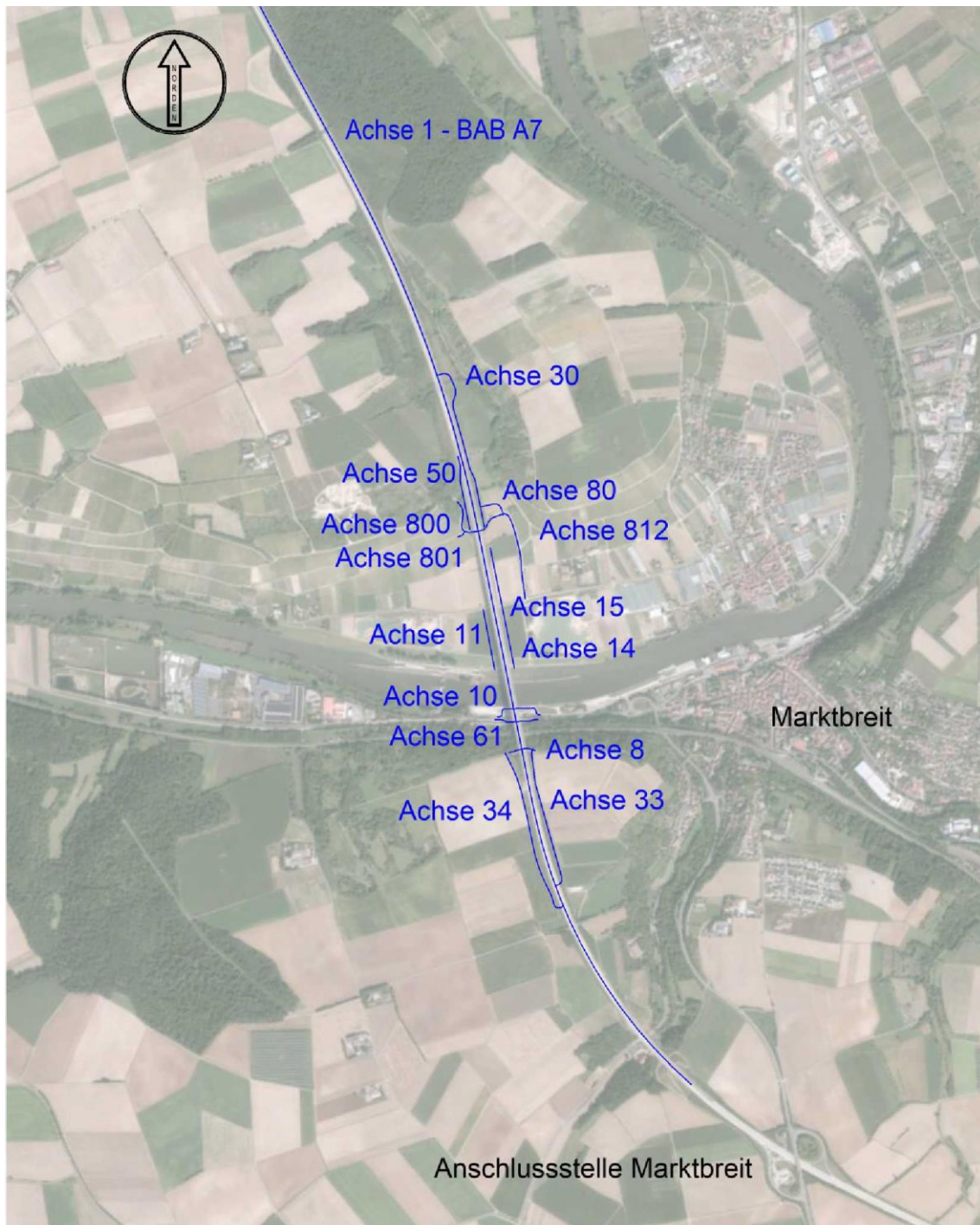
Anlage 1: Achsübersicht aller durch die Baumaßnahme berührten Straßen und Wege (einschl. Baustraßen)
