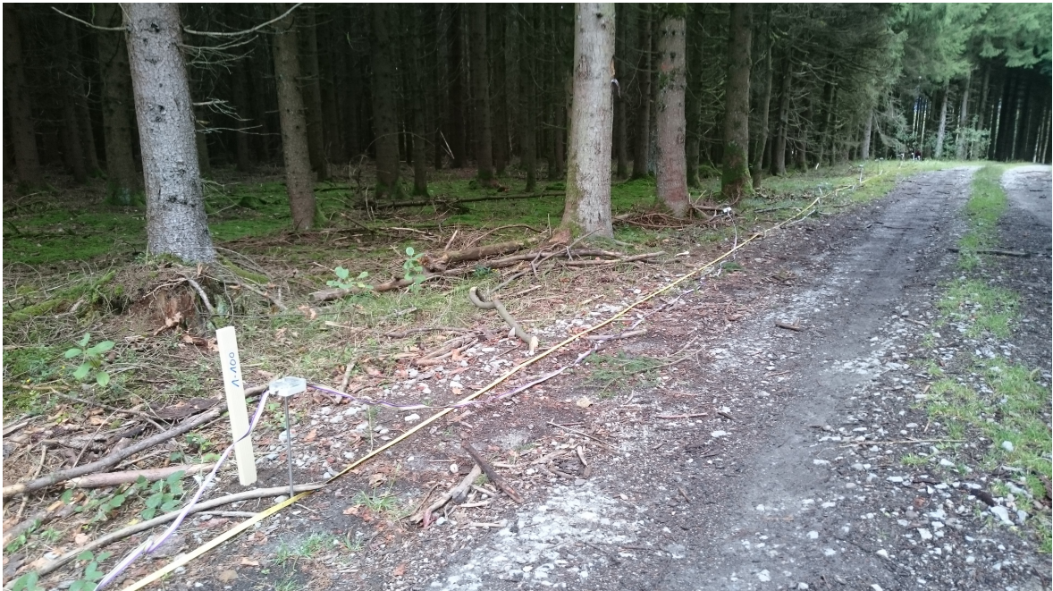
Foto 1: Pflöcke an der Profilposition 100 m am Profil Scheuereck 1. Das gelbe Maßband legt das Messprofil fest. Im Abstand von 5 m sind Edelstahl-Elektroden in den Erdboden gesteckt. Alle Elektroden sind über die ActEle Elektronikboxen und ein mehradriges Flachband- Buskabel seriell miteinander verbunden.
