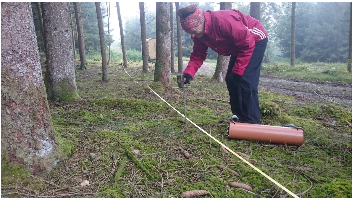
Foto 2: Beim Aufbau des Profils 3. Alle 5 m wird eine Edelstahl- Elektrode in den Erdboden gesteckt.
