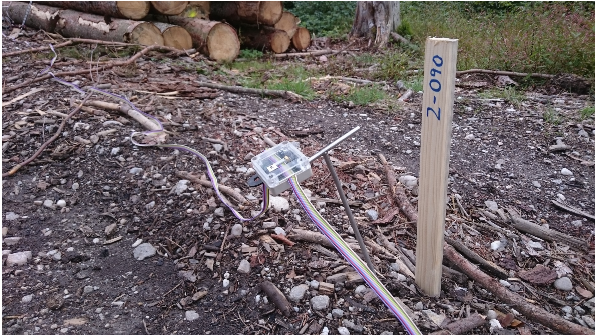
Foto 3: Beispiel eines Messpunkts, hier die Elektrode Nummer 19 bei Profilposition 90 m am Profil 2. Die T-förmige Edelstahl-Elektrode steckt im Erdboden. Das Buskabel ist über die Elektronikbox mit der Elektrode kontaktiert. Die Box enthält die Elektronik zur adressierten Ansteuerung der Elektrode wahlweise als Strom- oder Spannungselektrode (ActEle).
