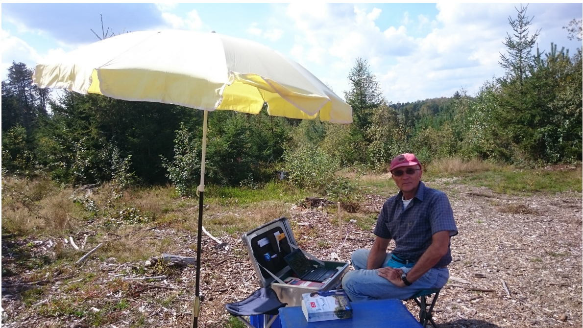
Foto 4: Die eigentliche geoelektrische Messung (hier am Profil 3) wird durch das Messgerät "4 Point Light 10W" (in der Alu-Box) durchgeführt. Das Messgerät ist über das ActEle Buskabel mit allen Elektroden verbunden. Die Alu-Box enthält auch den Netbook Rechner mit dem Messprogramm Geotest, welches die Messung steuert. Ein 12 V Blei-Gel Akku dient als Energiequelle.
