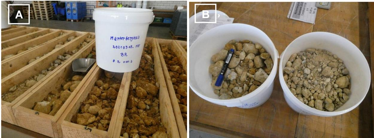
Bild A: Beprobung der ausgelegten Bohrung am S Rand der geplanten Abbaufäche im Marterbergholz. Ansatzpunkt bei 388 m NHN. Von 1 bis 22 m unter GOK konnte der Kies-Sand-Rohstoff aus den pliozänen bis pleistozänen Flussschottern, beprobt werden.
