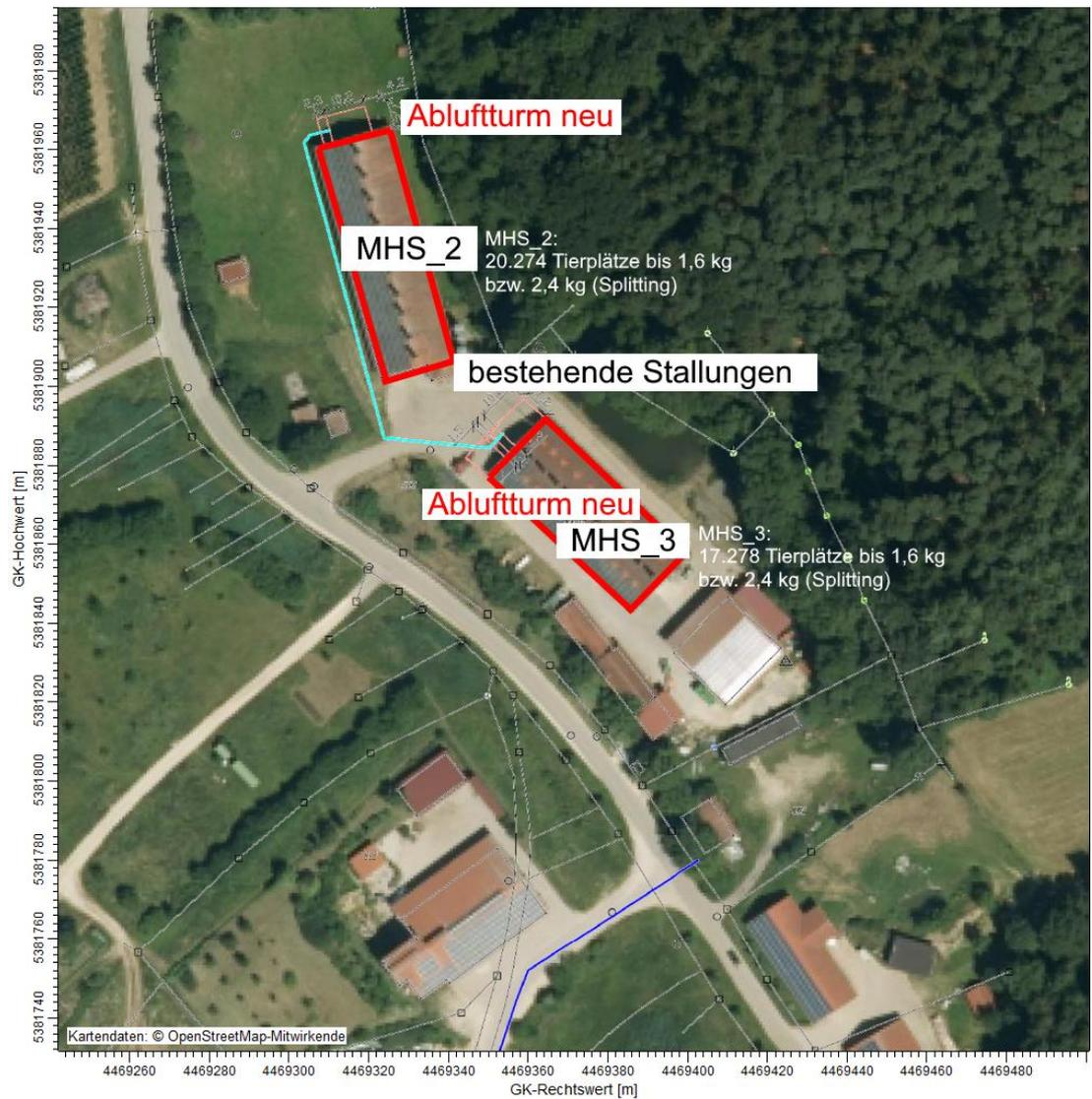
Abbildung 3. Lageplan der bestehenden Stallungen MHS\_2 und MHS\_3 mit geplanten Änderungen [24], Hintergrund: Bayerische Vermessungsverwaltung – [www.geodaten.bayern.de](http://www.geodaten.bayern.de) (CC BY 3.0 DE) [34].
