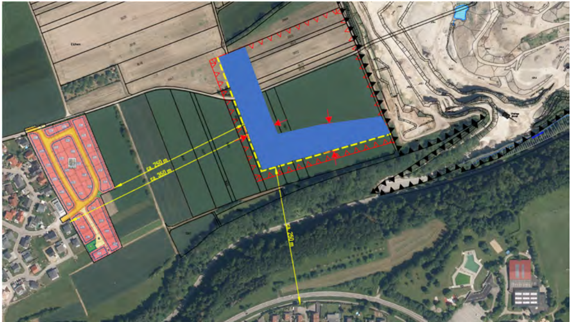
Abb. 6: Zukünftige Abbausituation. Blau gekennzeichnet sind die Flächen in denen im Vergleich zur bisherigen Sprengtechnik eine Ladungsteilung zu erwarten ist ( L_{\max} = 61 \text{ kg} ). Dieses betrifft Abstände zur Bebauung von 250 bis ca. 300 m.
