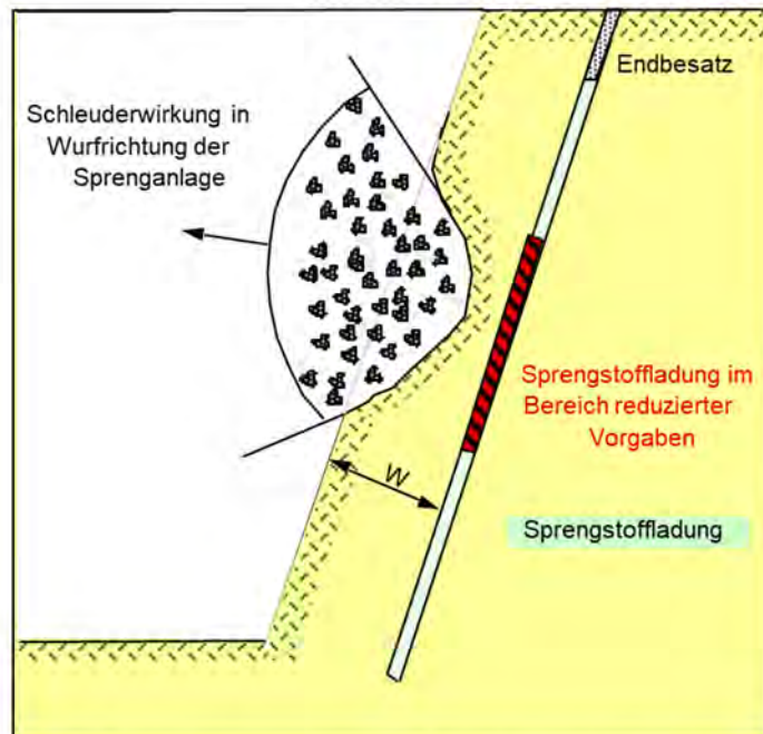
Abb. 5: Der Wandausbruch muß eingemessen werden und das Bohrloch in diesem Bereich mit Zwischenbesatz verfüllt sein.
