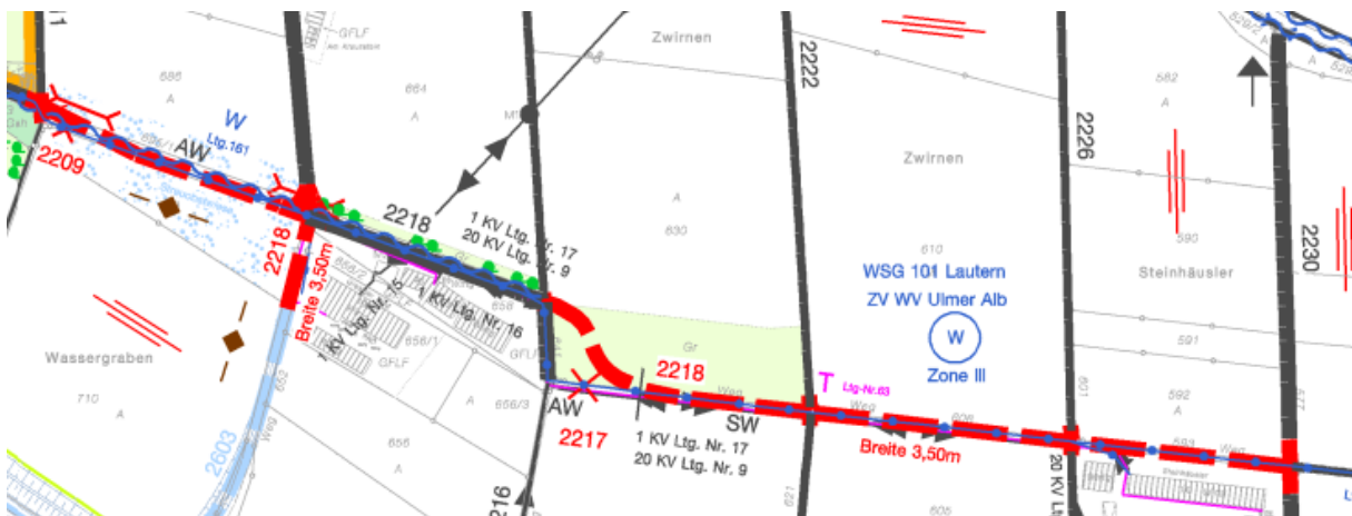
Abbildung 4 Ausbau und Asphaltierung des Schotterweges im Gewann „Hartgrund“ – Wege- und Gewässerkarte Stand 10.21
