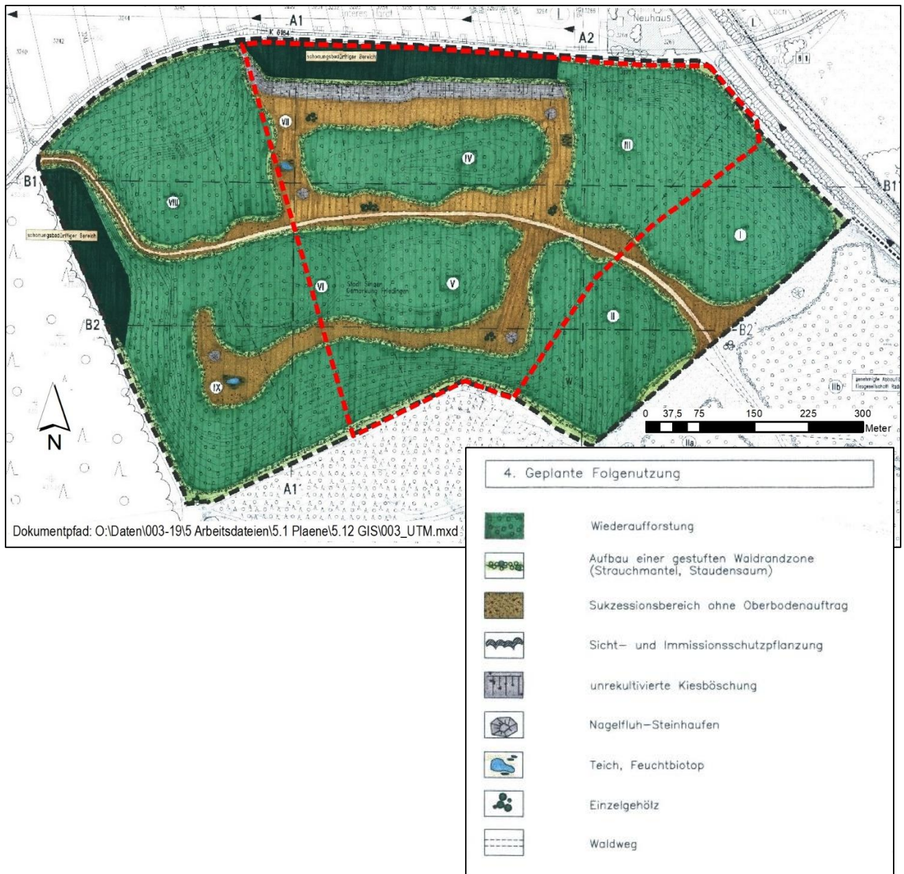
Abb. 21: Rekultivierungsleitplan des genehmigten Trockenabbaus mit Einblendung der Phase II (rot gestrichelte Linie)
