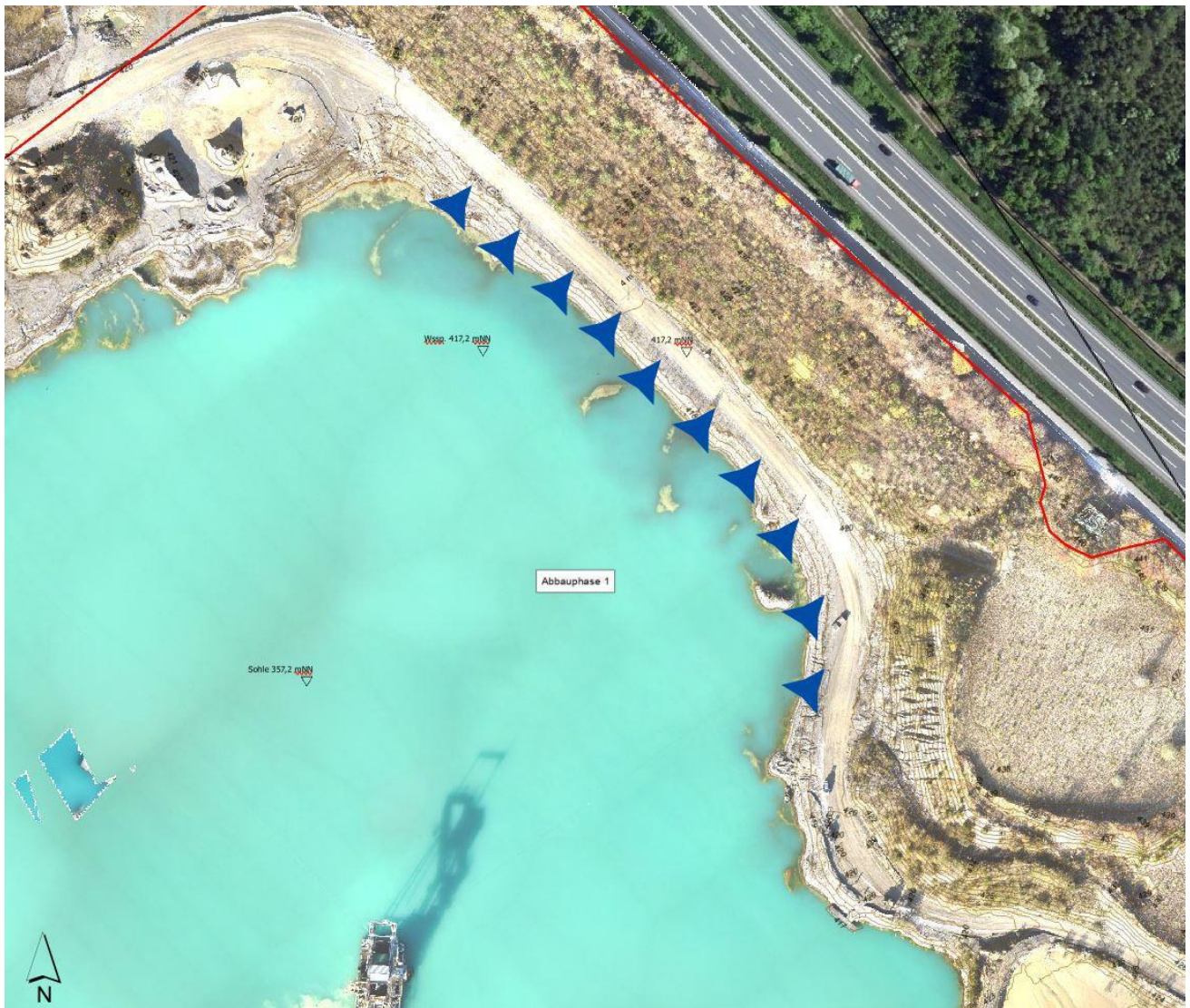
Abb. 4.6: Verlegung Flachwasserzone – neuer Bereich
