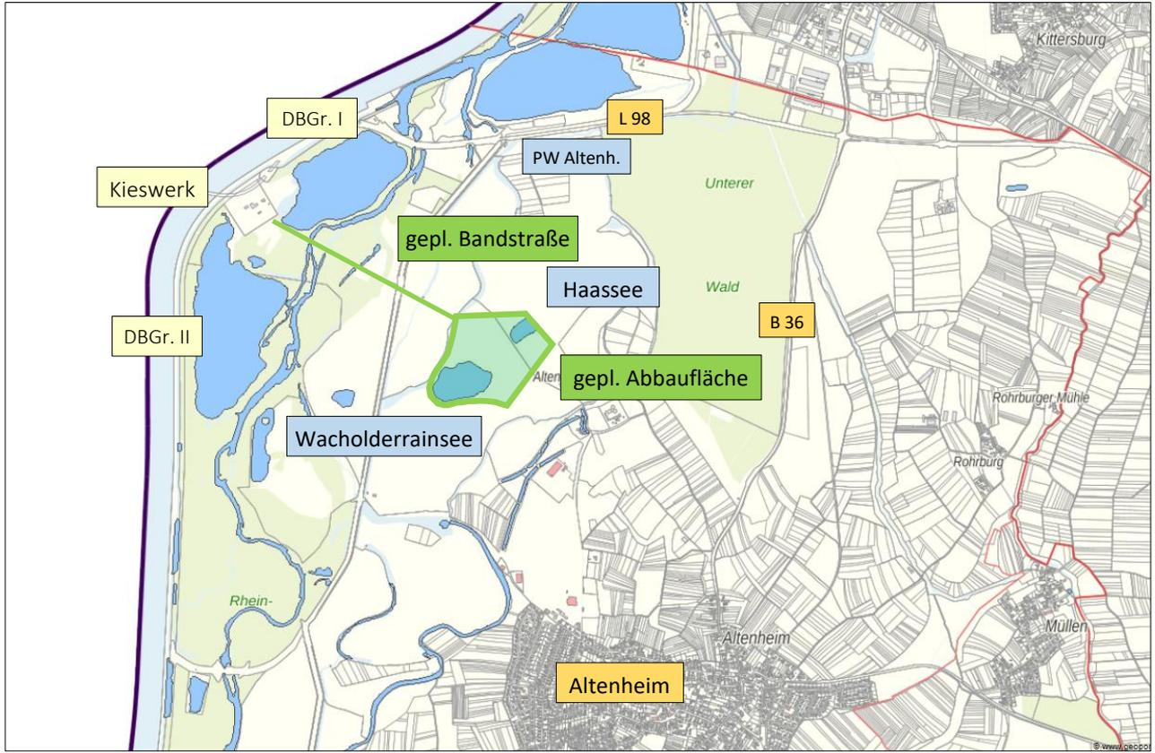
Abbildung 1-1: Bestehendes Kieswerk und geplante Abbaufläche „Datenquelle: LGL, [www.lgl-bw.de](http://www.lgl-bw.de)“
