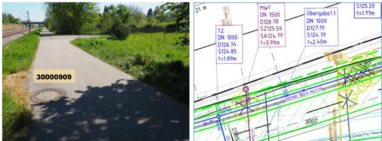
Bilder 19: Schacht 30000909 (Oberhaupt des Durchlass DN 1000 unterhalb DB-Strecke)
