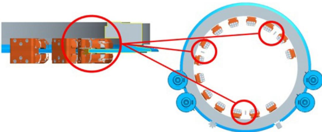
Abb. 4 *Schematische Darstellung Azimutlagerbereich mit Kennzeichnung der Schleifkontakte zur Blitzstromableitung*
