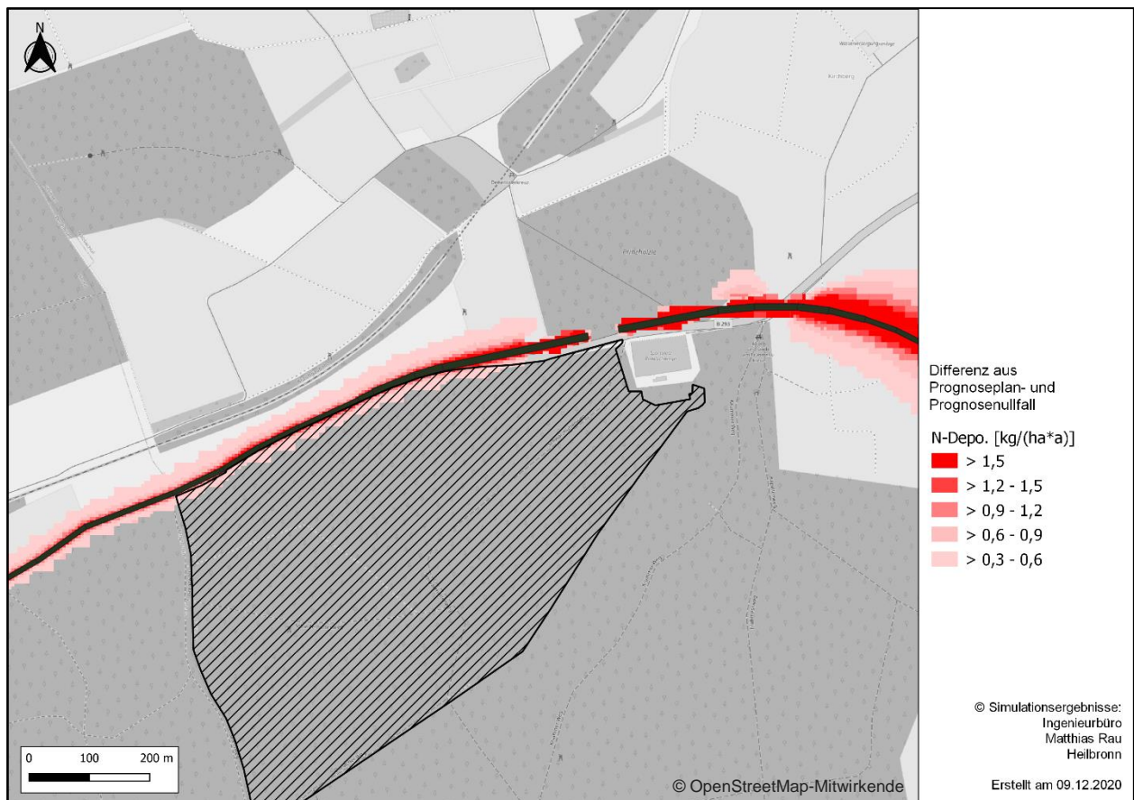
Abb. 21: Änderung der Stickstoffdeposition durch den Bau der Ortsumfahrung im Nahbereich des FFH-Gebietes im Westen des Untersuchungsgebietes.
