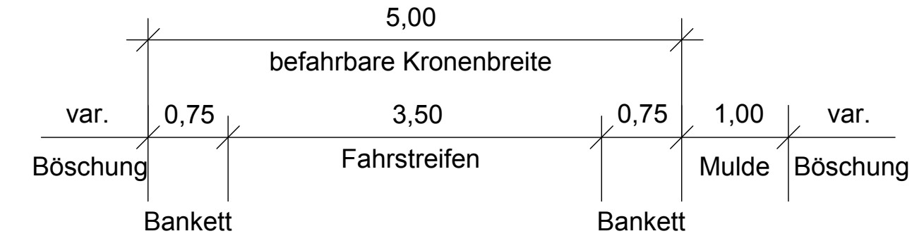
Verbindungsweg mit Asphaltdecke
