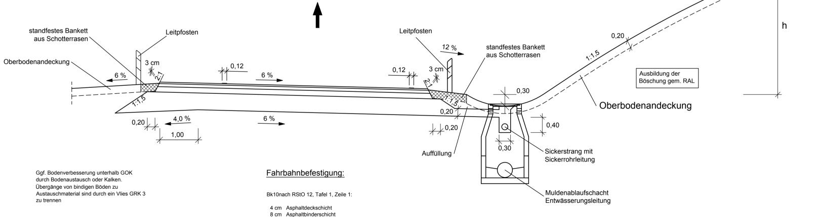
14 cm Asphalttragschicht 44 cm Frostschutzschicht 70 cm Gesamtdicke des Oberbaus
