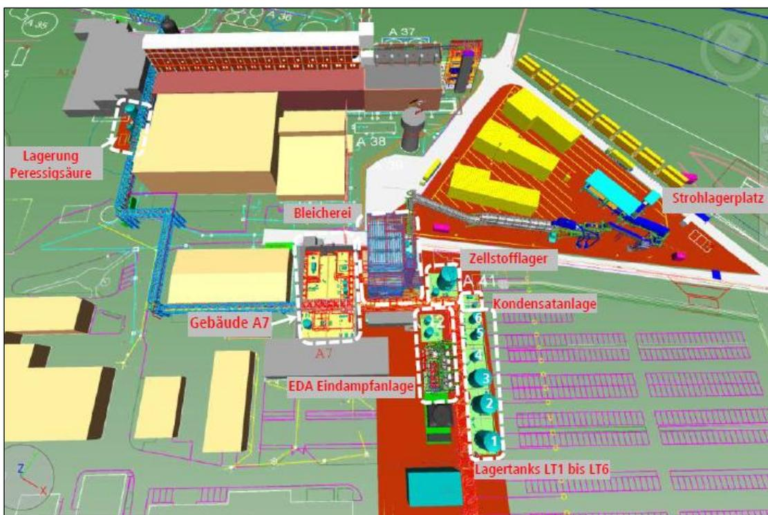
**Abbildung 4.** Übersicht über die geplante Anlage zur Herstellung von Zellstoff mit den einzelnen Konstruktionsbereichen, Quelle: Implenia [36]
