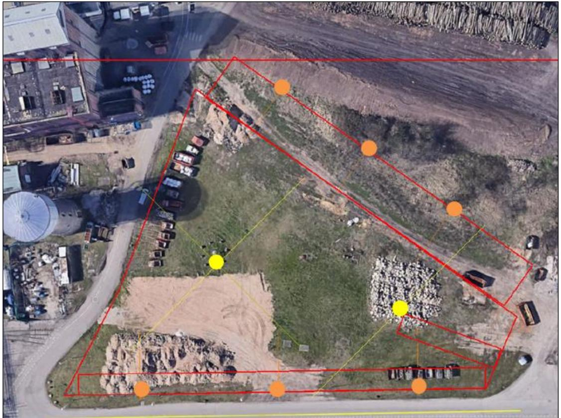
**Abbildung 9.** Grundriss der Aufstellungsorte der Flutlichter. Gelber Punkt = 16 m hohe Masten, orangener Punkt = 12 m hohe Masten [32]
