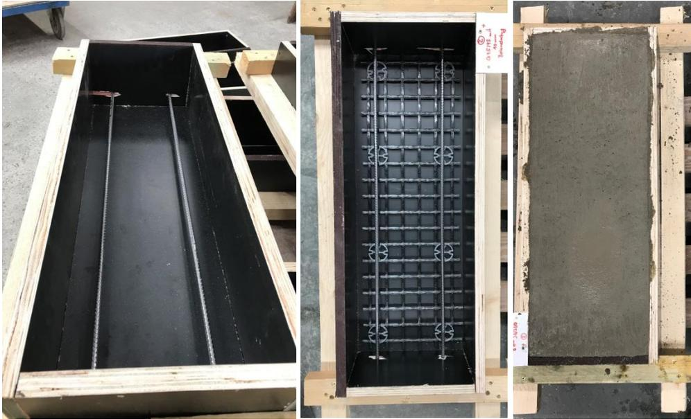
Bild 17 bis 19: Prüfkörperherstellung für Eindringversuche an gerissenen Prüfkörpern
