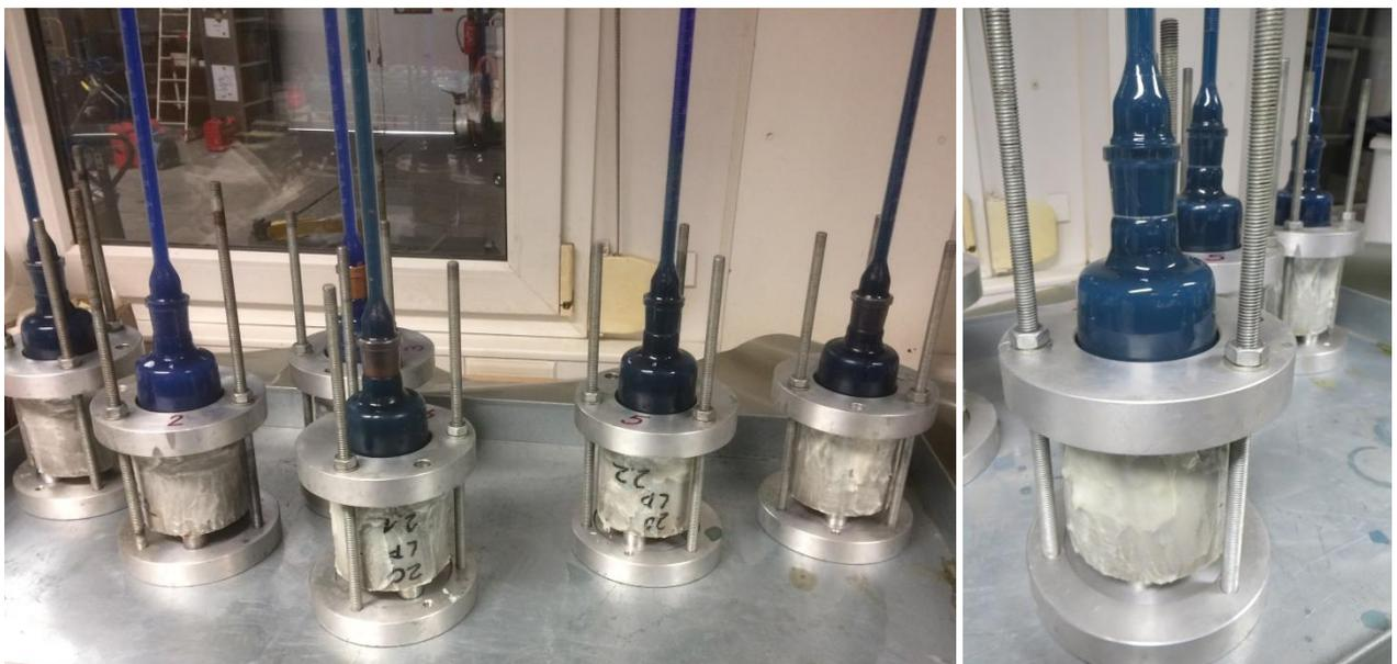
Bild 8 und 9: Eindringprüfungen mit blau eingefärbter Prüflüssigkeit
