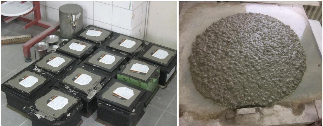
Bild 1 und 2: ein Teil der hergestellten Prüfkörper sowie Konsistenzüberprüfung
