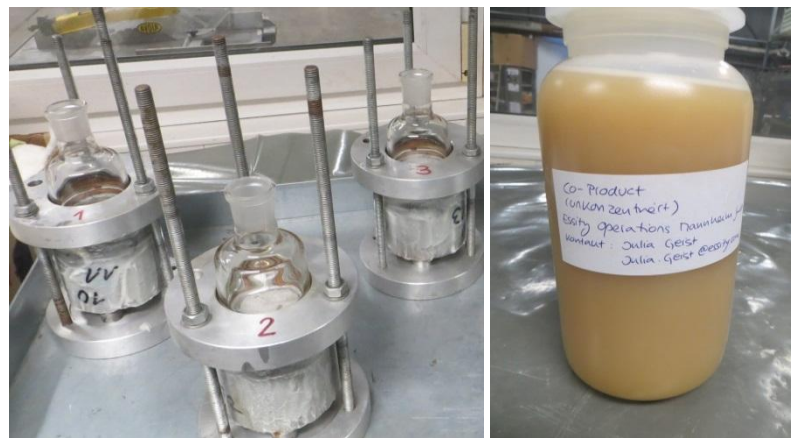
Bild 24 bis 26: Prüfvorrichtung zur Ermittlung der Eindringtiefe der Prüfflüssigkeit sowie vorbereitete ungerissene Prüfkörper; Einwirkhöhe 500 mm über 72 h
