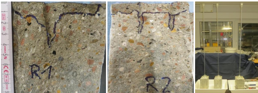
Bild 34 bis 36: Eindringtiefern in die Risse nach Aufspalten der Prüfkörper; Einwirkhöhe 1400 mm über 72 h
