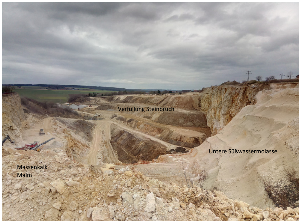
Abb. 2: Blick nach Nordosten, im Vordergrund gut zu erkennen sind die den Malmkalk überlagernden mächtigen Schichten der Unteren Süßwassermolasse
