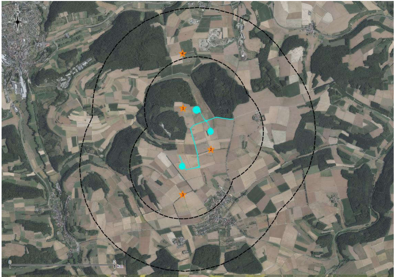
Abbildung 5: WEA-Standorte und RNA-Beobachtungspunkte im Untersuchungsgebiet. Unmaßstäblich. (hellblau: WEA-Standorte mit Zuwegung, orangene Sterne: RNA-Beobachtungspunkte, schwarz gestrichelt: 1000m- und 2000m-Radius). Luftbild: GeoBasis-DE / BKG (2019). Datengrundlage: EWE GmbH
