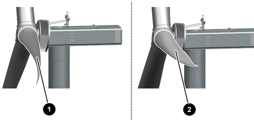
Abb. 3: Besondere Rotorblattstellungen
