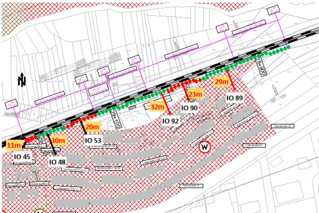
Abbildung 13: Errichtung der Schallschutzwand in Schwaigern; grün markiert sind die ungefähren Positionen der Pfähle, die gerammt werden dürfen, rot markiert sind die ungefähren Positionen der Pfähle, bei denen vor dem Rammen der Pfähle ein Lockern des Erdreichs zur Reduktion der Erschütterungen notwendig wird
