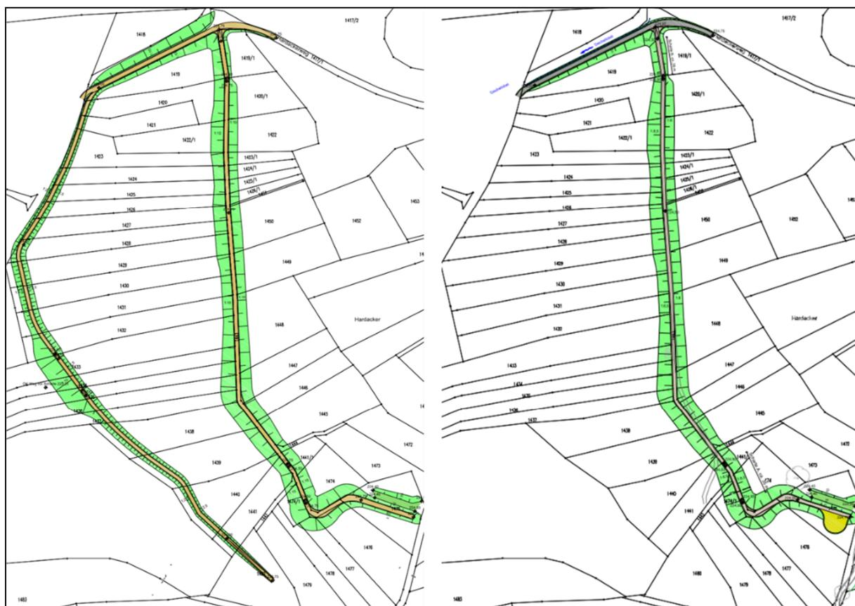
Abbildung 4-5: Ausbauvarianten für Schildkrötenkopf: li. Variante A mit zwei Retentionsriegeln; re.: Variante B mit einem Retentionsriegel (WALD + CORBE 2020)
