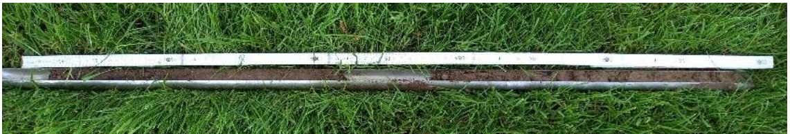
Abbildung 36: Bohrstockprofil N5 kalkreicher brauner Auenboden (Vega).
