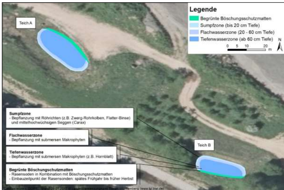
Abbildung 31: Uferumgestaltung der Himmelsteiche nahe des Nordportals des Tunnels Hirsau.
