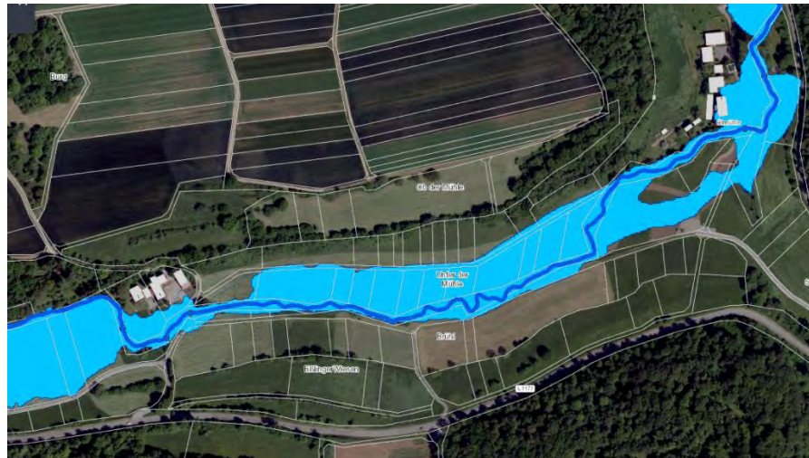
Abbildung 29: Überschwemmungsgebiet bei einem HQ 100 (IST-Zustand) HRB „Ölmühle“
