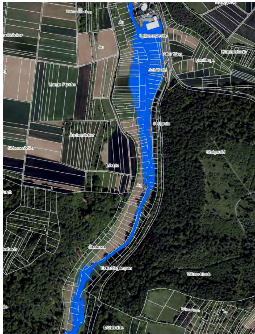
Abbildung 7: Eingestaute Flächen bei einem HQ_{10} (IST-Zustand) HRB „Eberdingen“
