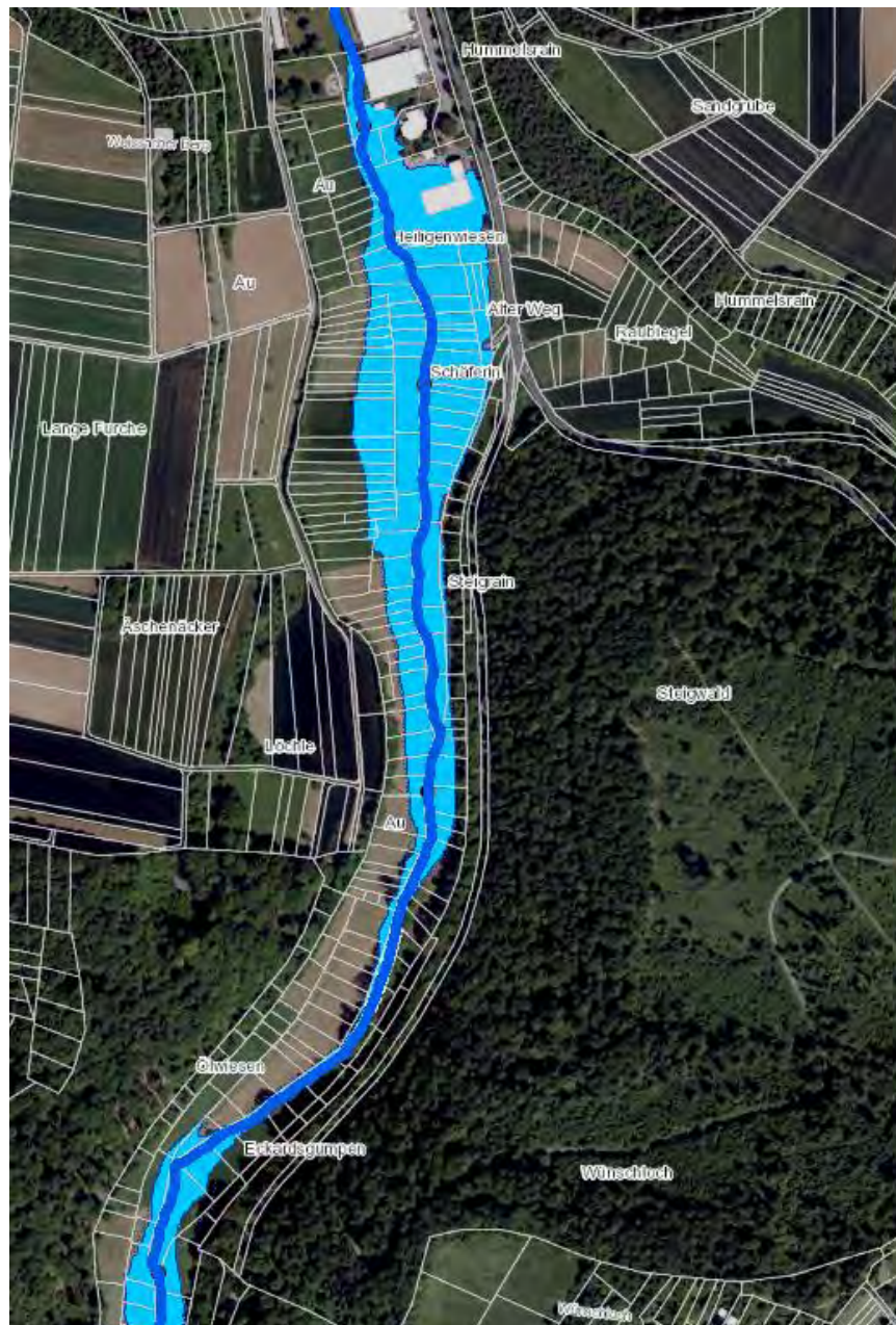
Abbildung 16: Überschwemmungsgebiet bei einem HQ 100 (IST-Zustand) HRB „Eberdingen“
