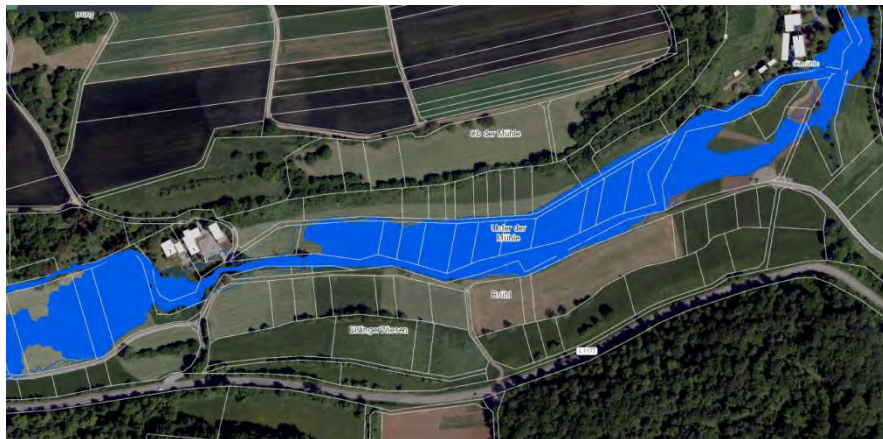
Abbildung 21: Eingestaute Flächen bei einem HQ 10 (IST-Zustand) „HRB „Ölmühle“
