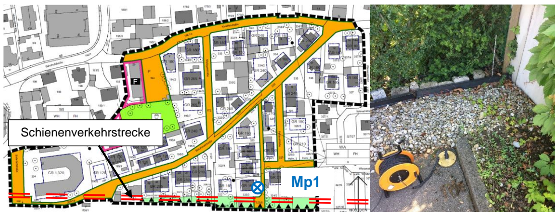
Abbildung 2. Prognose-Planfall - links: Plangebiet mit Lage der Messpunktes MP1 in Maisach, rechts: . Messpunkt Mp1, Hintergrund: Lärmschutzwand vor den Gleisen [12].
