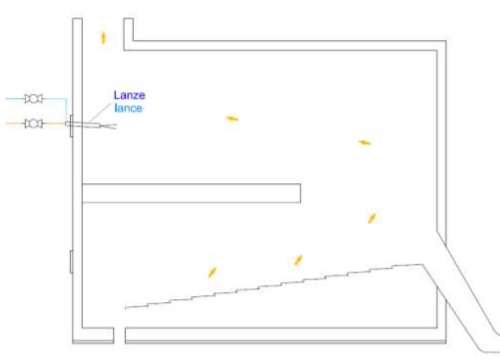
Abbildung 5: Schematische Darstellung der Eindüsung in die Nachverbrennungszone
