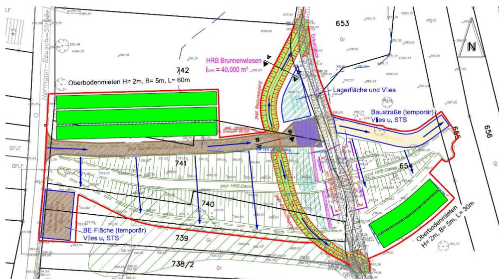
Abb. 8: temporäre Maßnahmen im Umfeld des Dammbauwerks, Quelle: Geotechnik Aalen
