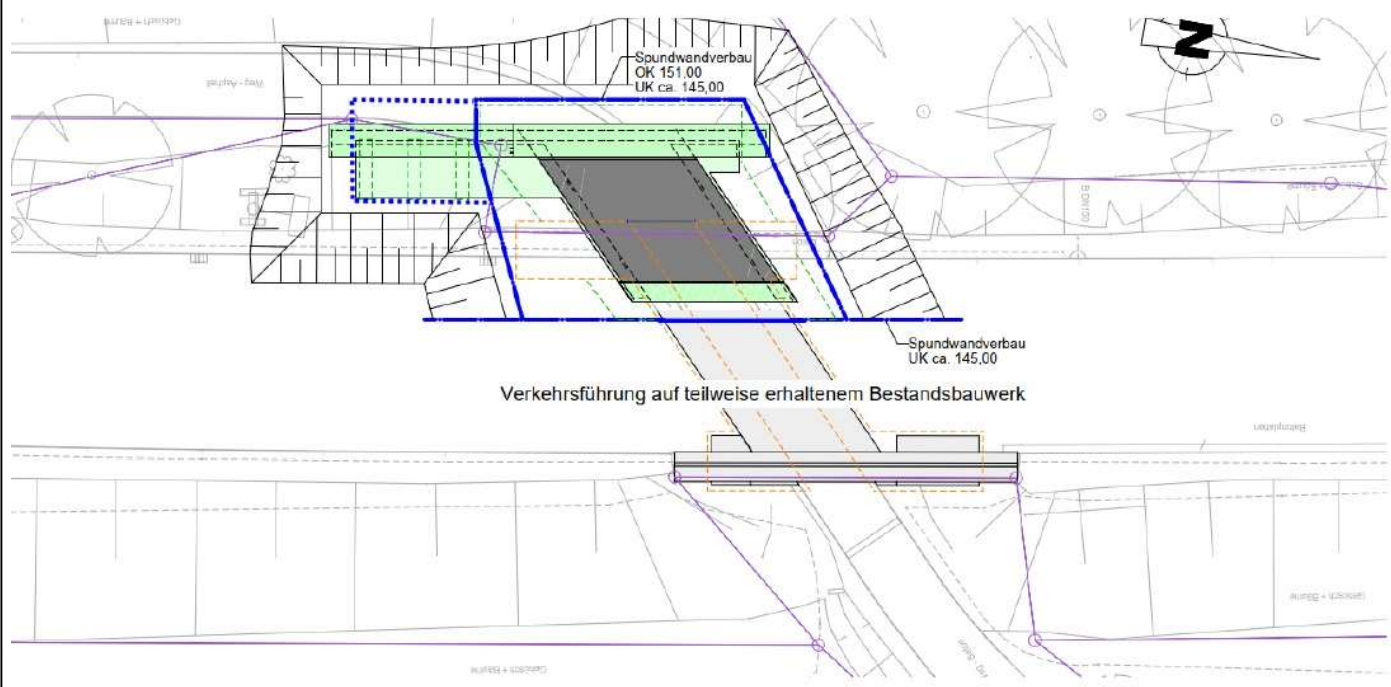
Grundriss Bauphase 2: Neubau Westseite
