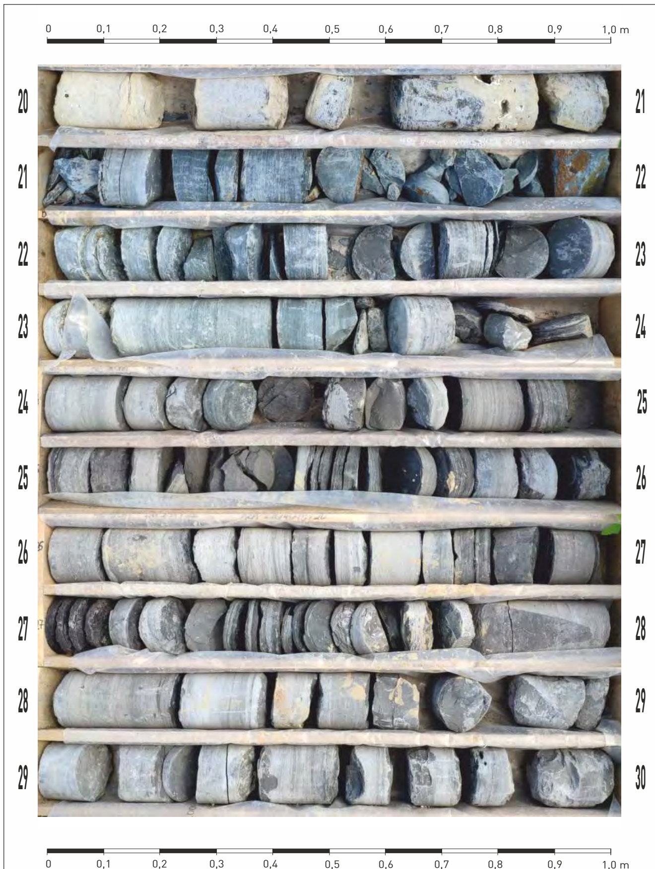
Bohrkernfotos der Kernbohrung BK 4 (20,0 - 30,0 m)
