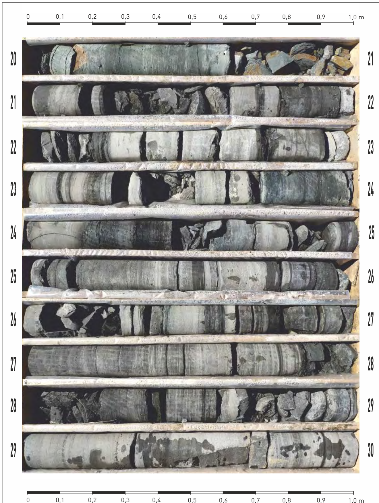
Bohrkernfotos der Kernbohrung BK 3 (20,0 - 30,0 m)
