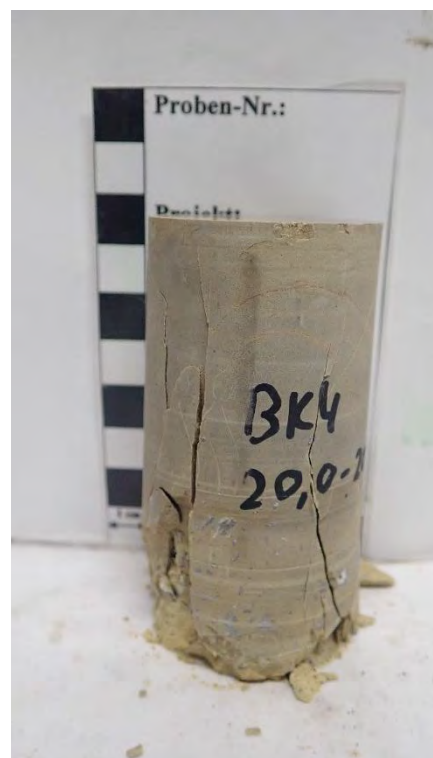
Abbildung 8: Einaxialer Druckversuch Probe BK4 20,00 – 20,10 m: Spannungs-Dehnungsdiagramm mit Ablesebereich des Verformungsmoduls, Probe vor dem Versuch, Probe nach dem Versuch.
