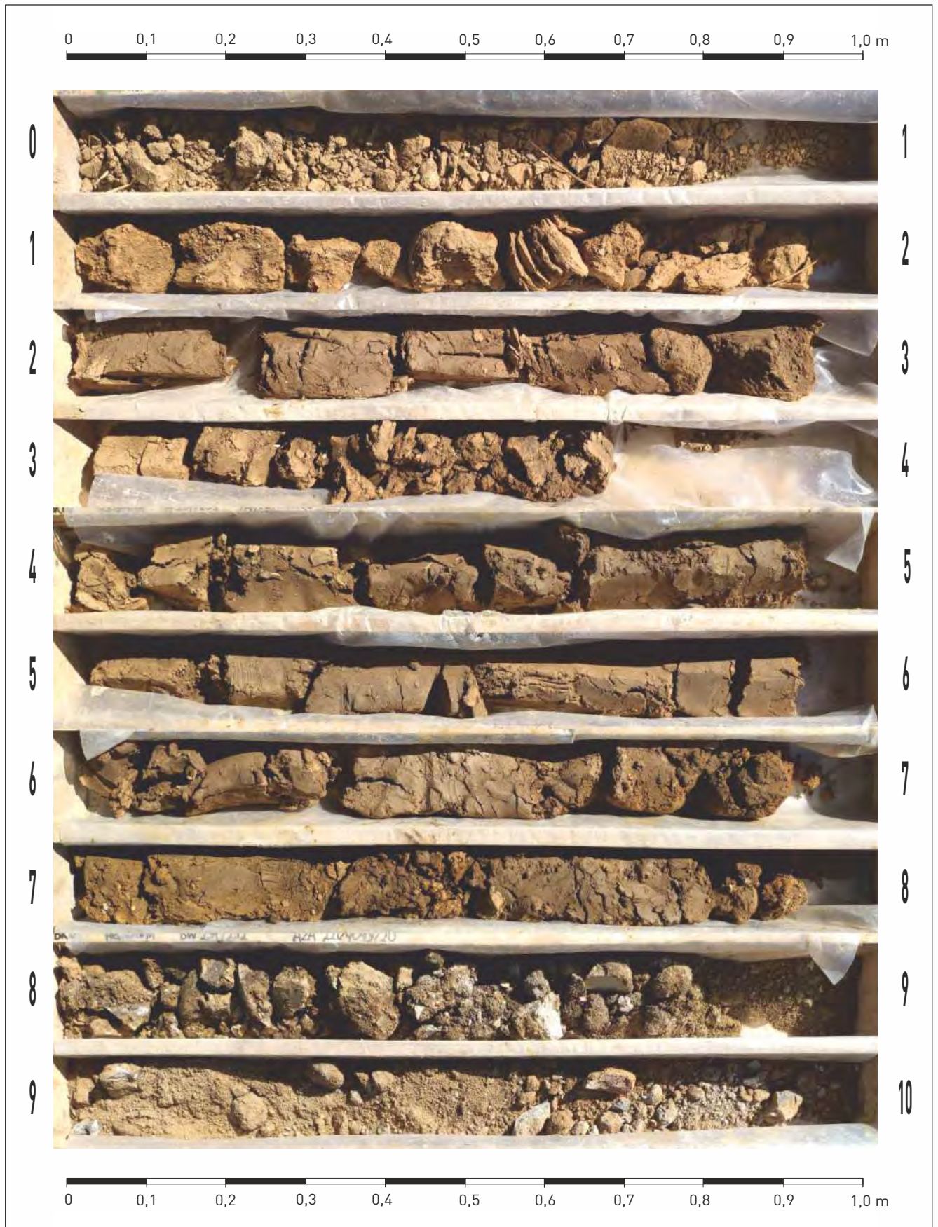
Bohrkernfotos der Kernbohrung BK 1 (0,0 - 10,0 m)
