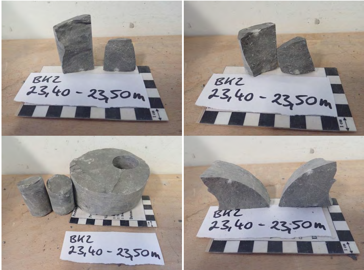
Abbildung 11: Probekörper nach Punktlastversuchen BK2 23,40 – 23,50 m.
