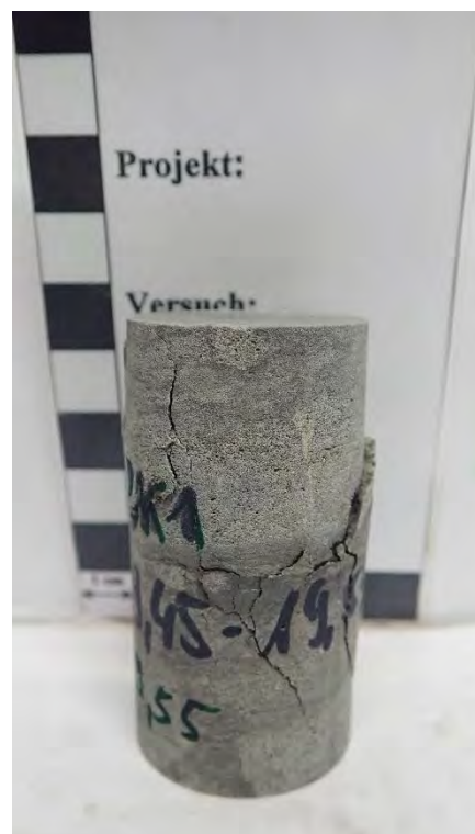
Abbildung 6: Einaxialer Druckversuch Probe BK1 19,45 – 19,55 m: Spannungs-Dehnungsdiagramm mit Ablesebereich des Verformungsmoduls, Probe vor dem Versuch, Probe nach dem Versuch.
