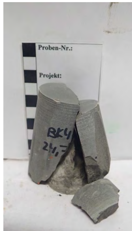
Abbildung 9: Einaxialer Druckversuch Probe BK4 24,70 – 24,80 m: Spannungs-Dehnungsdiagramm mit Ablesebereich des Verformungsmoduls, Probe vor dem Versuch, Probe nach dem Versuch.
