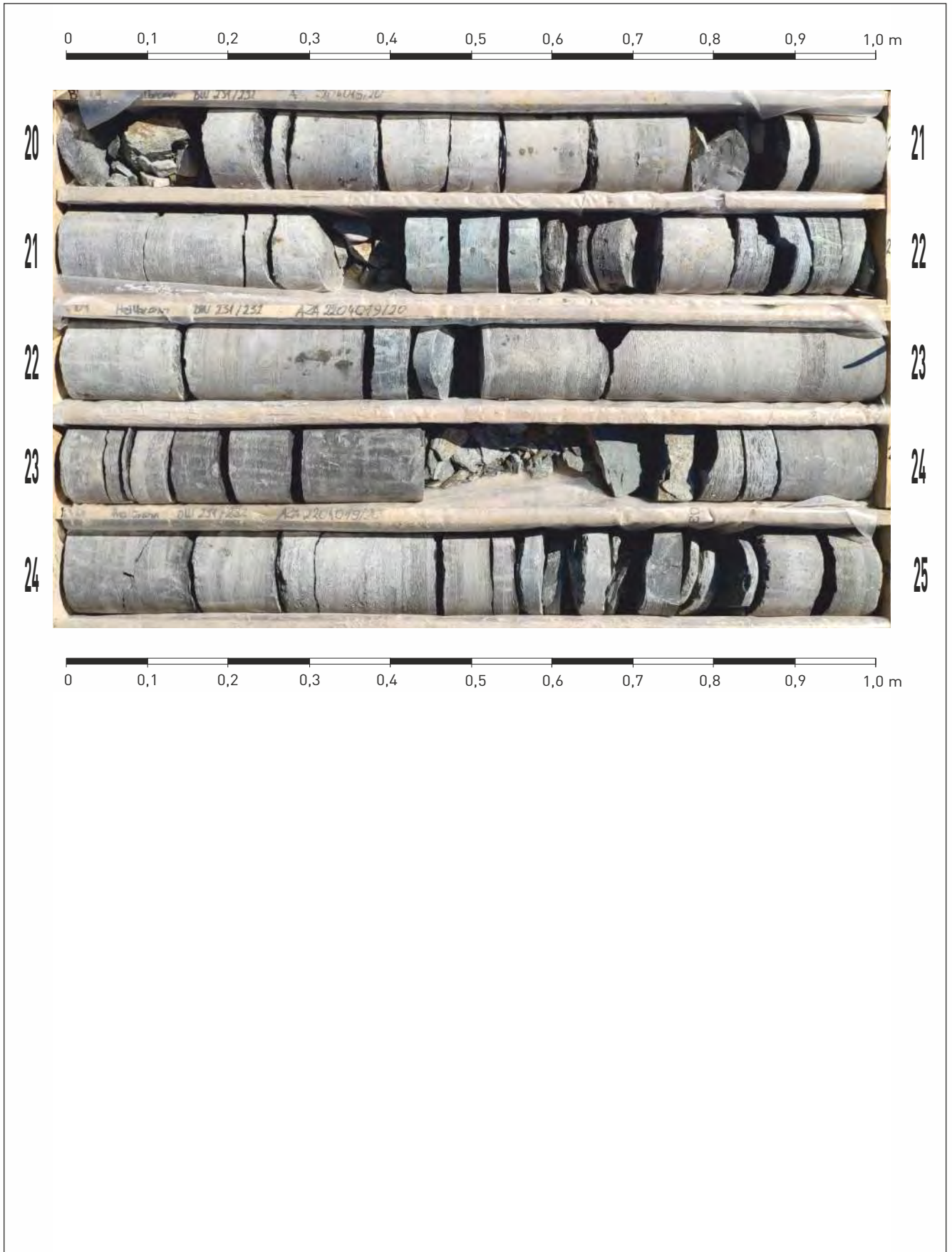
Bohrkernfotos der Kernbohrung BK 1 (20,0 - 25,0 m)
