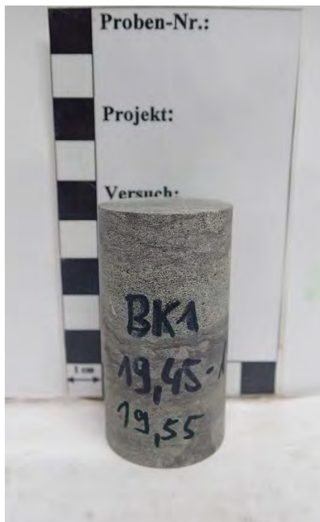
Abbildung 6: Einaxialer Druckversuch Probe BK1 19,45 – 19,55 m: Spannungs-Dehnungsdiagramm mit Ablesebereich des Verformungsmoduls, Probe vor dem Versuch, Probe nach dem Versuch.
