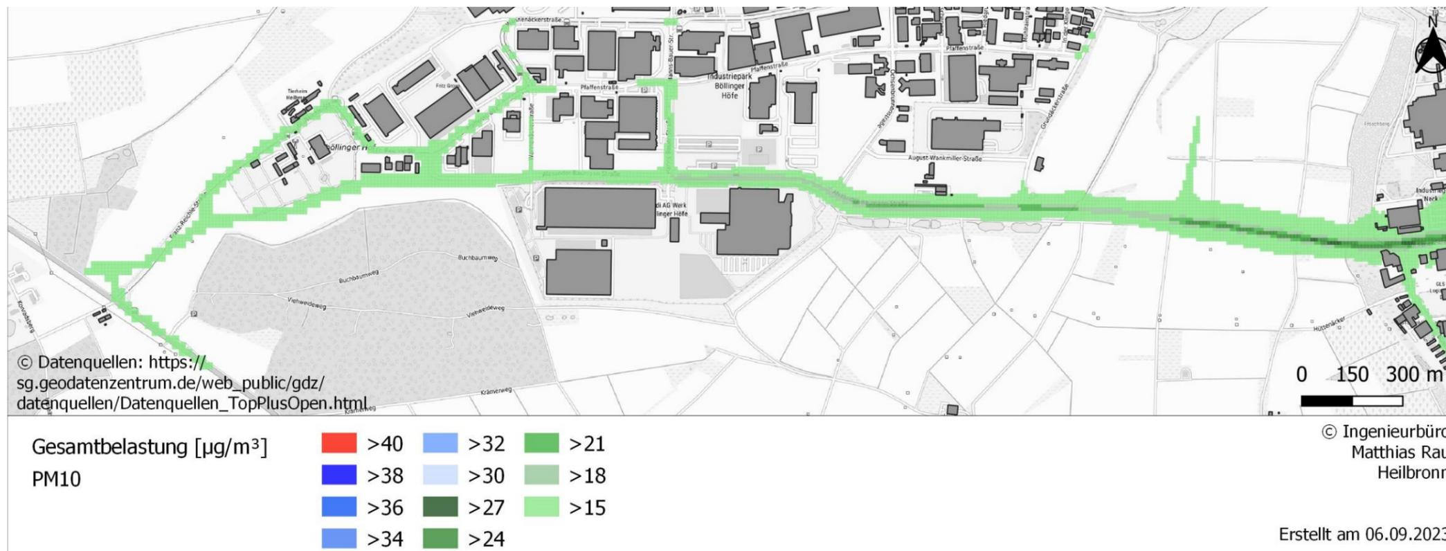
Abb. 7-8: Nordumfahrung: Prognose der PM10-Jahresmittelwerte der Immissionsgesamtbelastung für den Prognoseplanfall in 1,5 m Höhe über Geländeneiveau.
