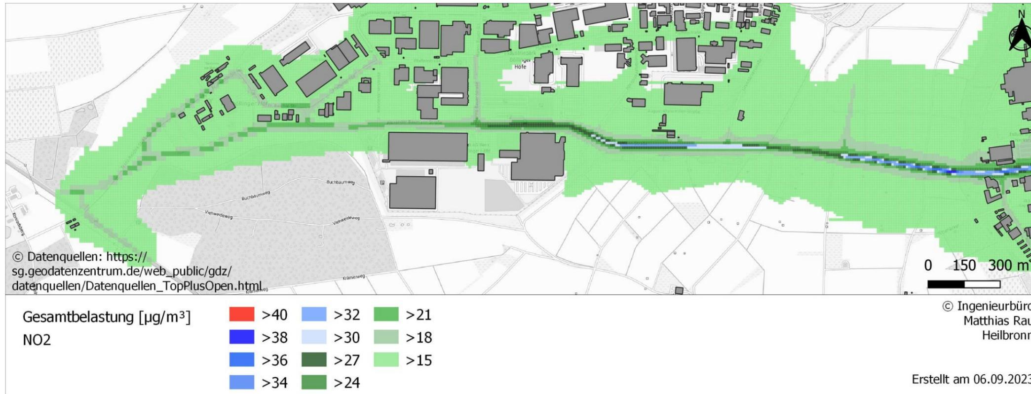
Abb. 7-7: Nordumfahrung: Prognose der NO<sub>2</sub>-Jahresmittelwerte der Immissionsgesamtbelastung für den Prognoseplanfall in 1,5 m Höhe über Geländeneiveau.
