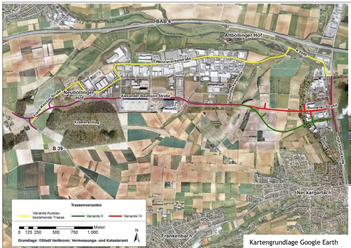
**Abbildung 4-14:** Untersuchte Trassenvarianten für die Nordumfahrung
