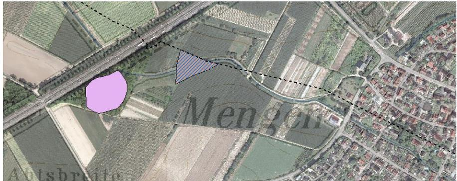
Abb. 4: Flächen westlich von Mengen, in denen Bodensackungen aufgrund der Grundwasserabsenkung möglich sind. Schraffiert: Kalkhaltiges Gley-Kolluvium aus holozänen Abschwemmassen; Rosa: Kalkhaltiger Gley über Niedermoor aus Schwemmsediment über Niedermoor torf.
