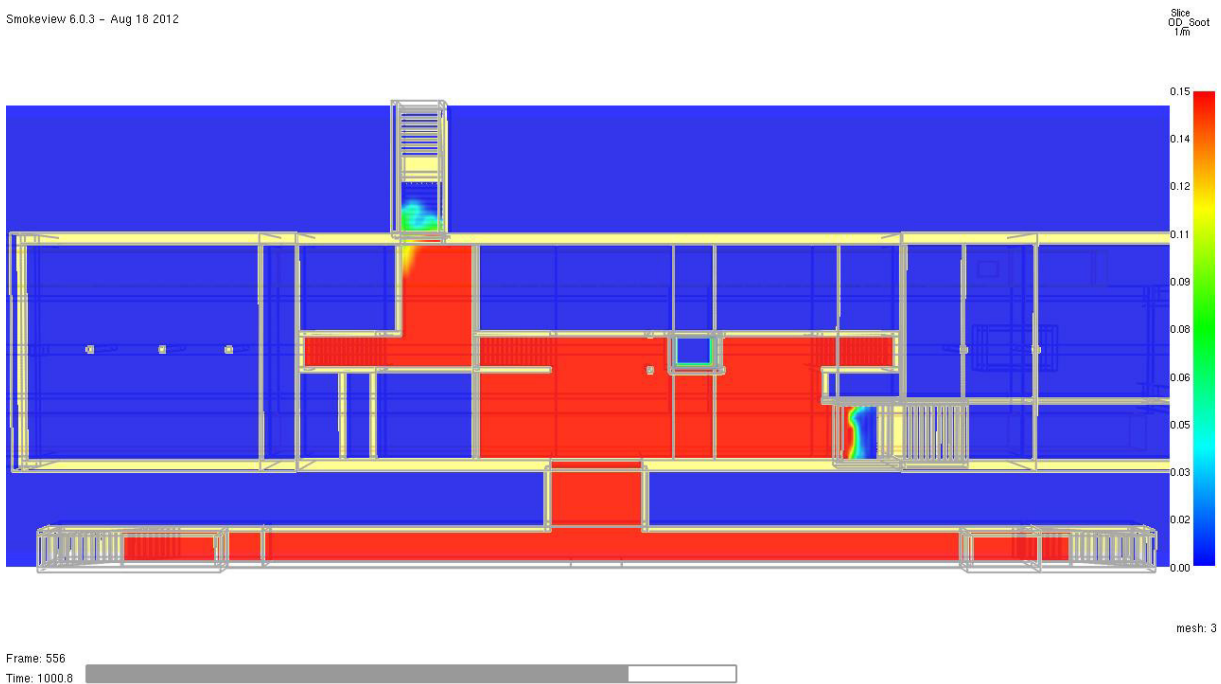
Abb. 52 Optische Rauchdichte in 1/m zum Zeitpunkt t = 1.000 Sekunden im Horizontalschnitt in 2,0 m Höhe über dem Fußboden der Verteilerebene . Ab ca. diesem Zeitpunkt ist die Erreichbarkeit des geänderten Notausgangs nicht mehr gegeben.
