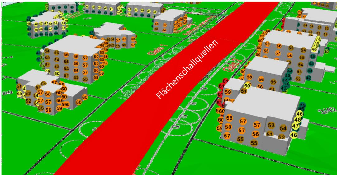
Abb. 9.1: 3D-Ansicht Fassadenpegel ohne Lärmschutzwand – Sicht: Argentinische Allee
