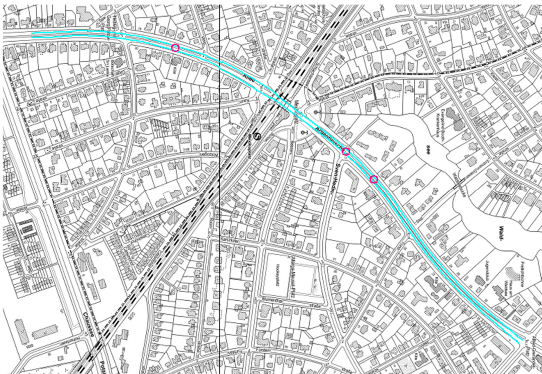
Abb. 7.4: Lage der Weichen (rote Kreise) im Tunnelbauwerk
