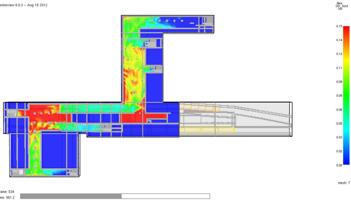
Abb. 38 Optische Rauchdichte in 1/m zum Zeitpunkt t = 960 Sekunden im Horizontalschnitt in 2,0 m Höhe über dem Fußboden der Zwischenebene . Ab ca. diesem Zeitpunkt ist diese Ebene in weiten Bereichen nicht mehr passierbar.
