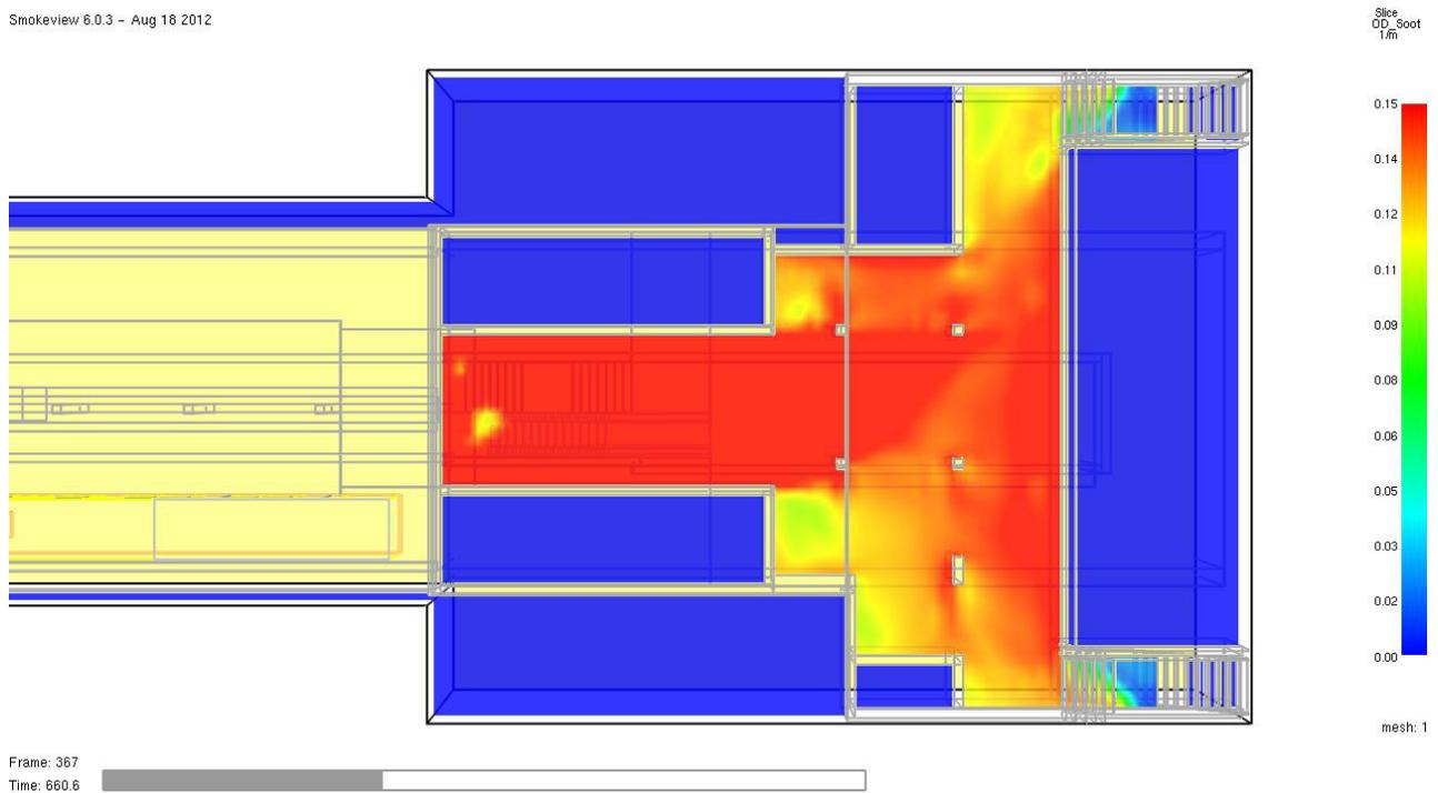
Abb. 46 **Optische Rauchdichte** in 1/m zum Zeitpunkt **t = 660 Sekunden** im Horizontalschnitt in 2,0 m Höhe über dem Fußboden der **Schalterhalle II**. Ab ca. diesem Zeitpunkt ist der größte Bereich der Schalterhalle verrauchet. Die Zugänge zu den Ausgängen sind noch nutzbar.
