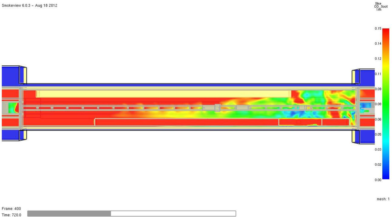
Abb. 44 **Optische Rauchdichte** in 1/m zum Zeitpunkt **t = 720 Sekunden** im Horizontalschnitt in 2,0 m Höhe über dem Fußboden des **Bahnsteigs**. Ab ca. diesem Zeitpunkt ist der Bahnsteig nicht mehr passierbar, da der Bereich vor dem nördlichen Ausgang in die Schalterhalle II großflächig verrauchte ist.
