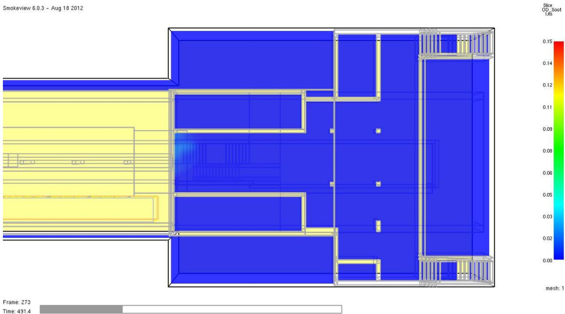
Abb. 25 **Optische Rauchdichte** in 1/m zum Zeitpunkt **t = 490 Sekunden** (8,2 Minuten = Evakuierungszeit) im Horizontalschnitt in 2,0 m Höhe über dem Fußboden der **Schalterhalle II**. Der Grenzwert von 0,15 1/m wird in dieser Ebene nicht erreicht. Das Schutzziel wird zu diesem Zeitpunkt erfüllt. Die flüchtenden Personen befinden sich schon im Freien.
