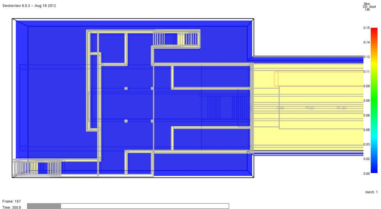
Abb. 18 **Optische Rauchdichte in 1/m zum Zeitpunkt  $t = 300$  Sekunden** im Horizontalschnitt in 2,0 m Höhe über dem Fußboden der **Schalterhalle I**. Das Schutzziel wird zu diesem Zeitpunkt vollumfänglich erfüllt.
