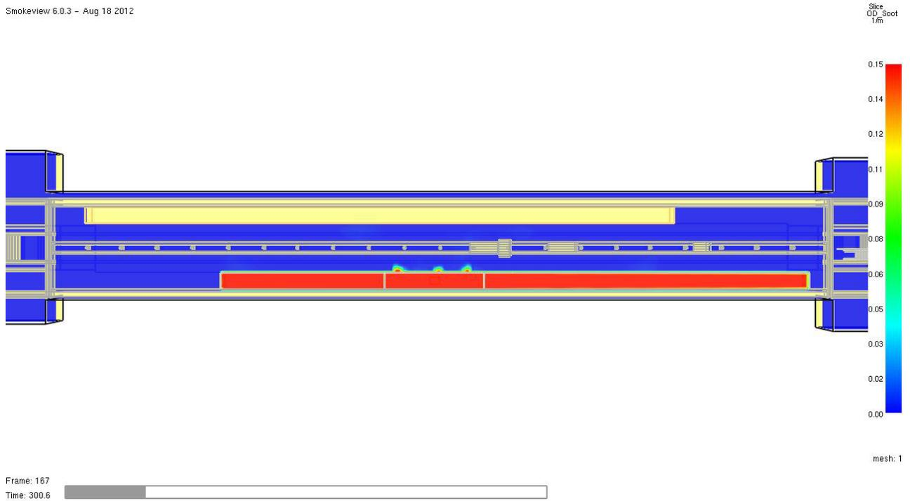
Abb. 17 **Optische Rauchdichte in 1/m zum Zeitpunkt  $t = 300$  Sekunden** im Horizontalschnitt in 2,0 m Höhe über dem Fußboden des **Bahnsteigs**. Das Schutzziel wird zu diesem Zeitpunkt erfüllt.
