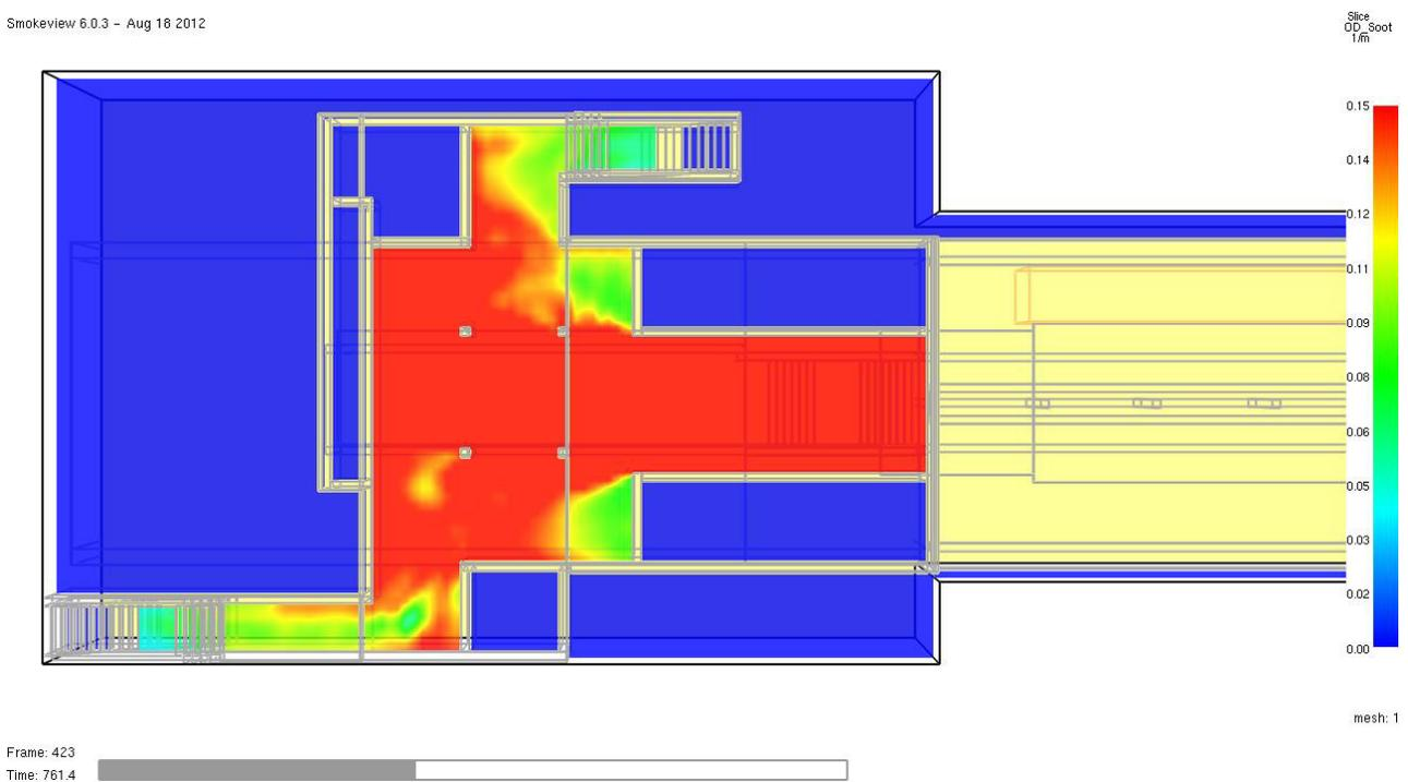
Abb. 45 **Optische Rauchdichte** in 1/m zum Zeitpunkt **t = 760 Sekunden** im Horizontalschnitt in 2,0 m Höhe über dem Fußboden der **Schalterhalle I**. Ab ca. diesem Zeitpunkt ist der größte Bereich der Schalterhalle verrauchte. Die Ausgänge sind noch nutzbar.
