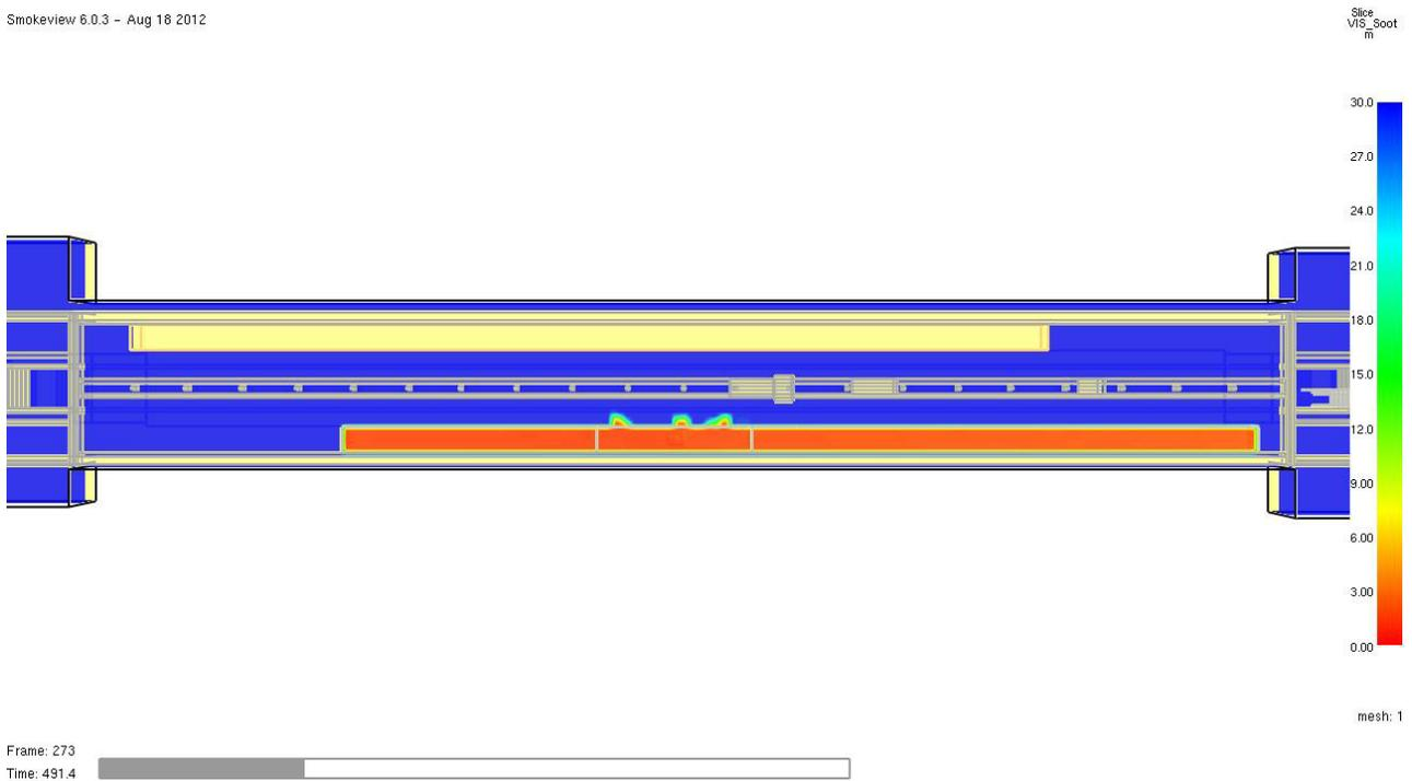
Abb. 27 **Erkennungsweite in m** zum Zeitpunkt **t = 490 Sekunden** (8,2 Minuten = Evakuierungszeit) im Horizontalschnitt in 2,0 m Höhe über dem Fußboden des **Bahnsteigs**. Das Schutzziel wird vollumfänglich erfüllt.
