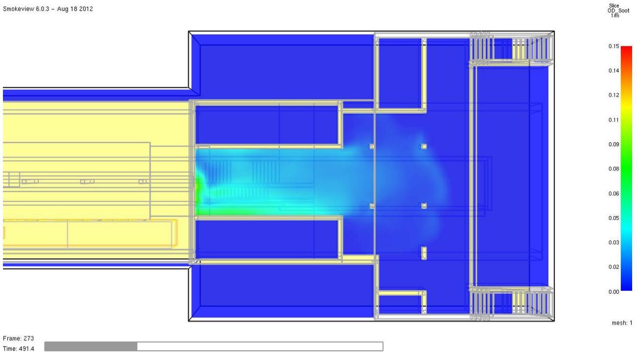
Abb. 40 **Optische Rauchdichte** in 1/m zum Zeitpunkt **t = 490 Sekunden** (8,2 Minuten = Evakuierungszeit) im Horizontalschnitt in 2,0 m Höhe über dem Fußboden der **Schalterhalle II**. Der Grenzwert von 0,15 1/m wird nicht erreicht. Das Schutzziel wird zu diesem Zeitpunkt erfüllt. Alle flüchtenden Personen befinden sich schon im Freien.
