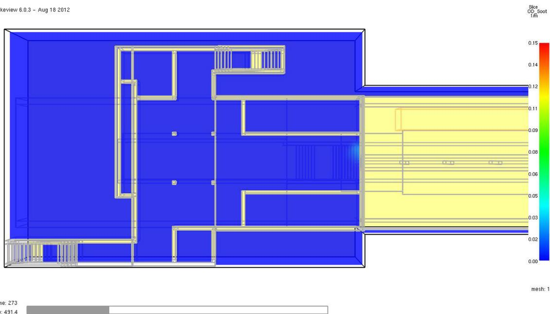
Abb. 24 **Optische Rauchdichte** in 1/m zum Zeitpunkt **t = 490 Sekunden** (8,2 Minuten = Evakuierungszeit) im Horizontalschnitt in 2,0 m Höhe über dem Fußboden der **Schalterhalle I**. Der Grenzwert von 0,15 1/m wird nicht erreicht. Das Schutzziel wird zu diesem Zeitpunkt vollumfänglich erfüllt. Die flüchtenden Personen befinden sich zu diesem Zeitpunkt im Freien.
