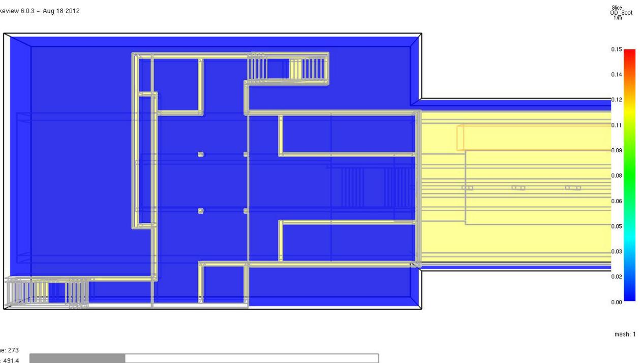
Abb. 39 **Optische Rauchdichte** in 1/m zum Zeitpunkt **t = 490 Sekunden** (8,2 Minuten = Evakuierungszeit) im Horizontalschnitt in 2,0 m Höhe über dem Fußboden der **Schalterhalle I**. Der Grenzwert von 0,15 1/m wird nicht erreicht. Die flüchtenden Personen befinden sich zu diesem Zeitpunkt schon im Freien.
