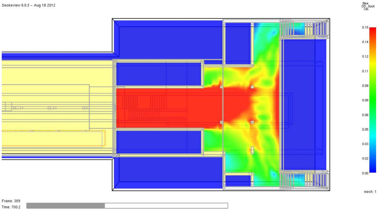
Abb. 31 **Optische Rauchdichte** in 1/m zum Zeitpunkt **t = 700 Sekunden** im Horizontalschnitt in 2,0 m Höhe über dem Fußboden der **Schalterhalle II**. Ab ca. diesem Zeitpunkt ist der größte Bereich der Schalterhalle verrauchte. Die Zugänge zu den Ausgängen sind noch nutzbar.
