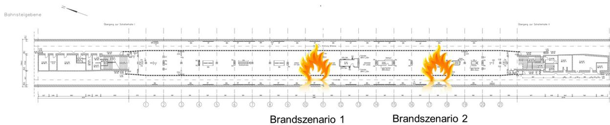
Abb. 13 Position des brennenden Triebwagens für Szenario 1 und 2
