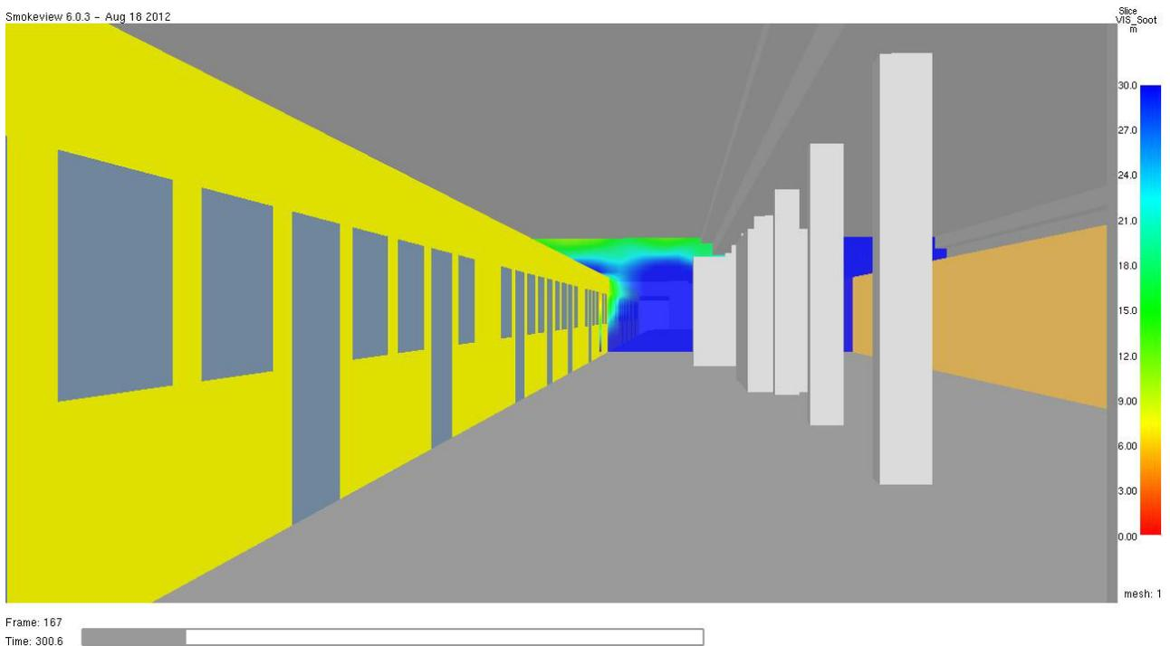
Abb. 22 **Erkennungsweite in m** zum Zeitpunkt **t = 300 Sekunden** im Vertikalschnitt durch den Brandherd und Bahnhof
