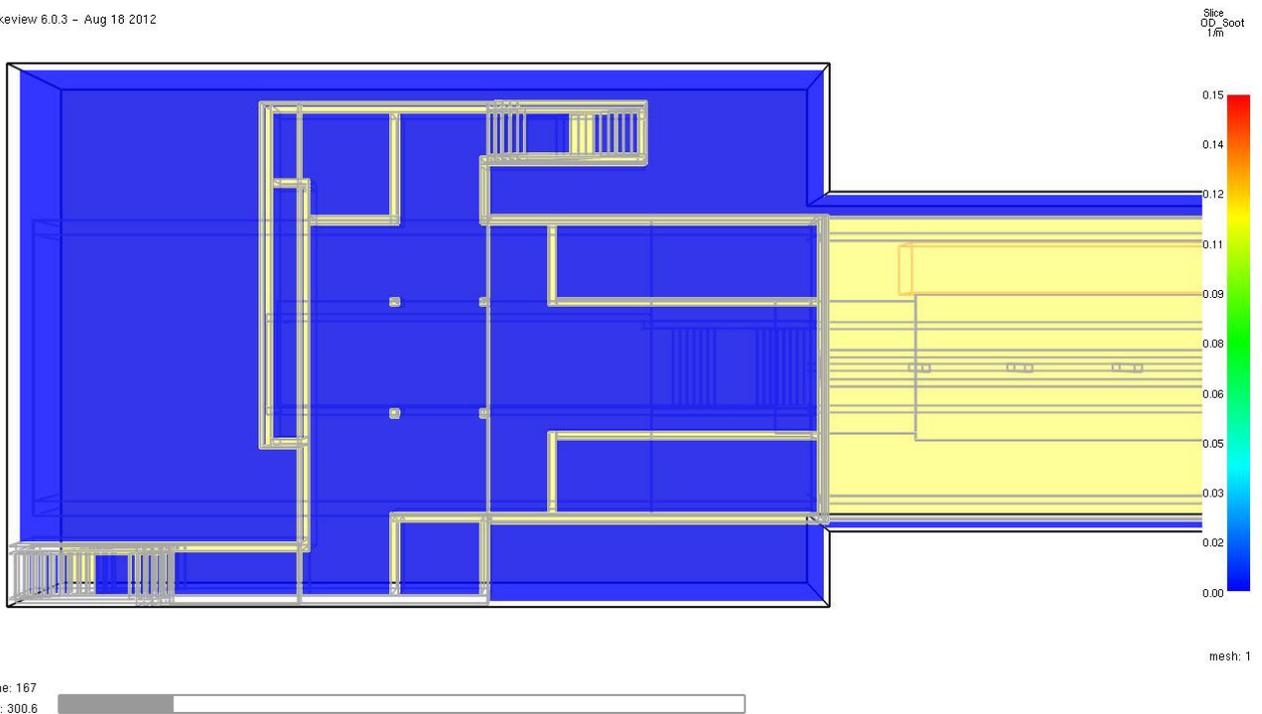
Abb. 33 **Optische Rauchdichte in 1/m** zum Zeitpunkt **t = 300 Sekunden** im Horizontalschnitt in 2,0 m Höhe über dem Fußboden der **Schalterhalle I**. Das Schutzziel wird zu diesem Zeitpunkt vollumfänglich erfüllt.
