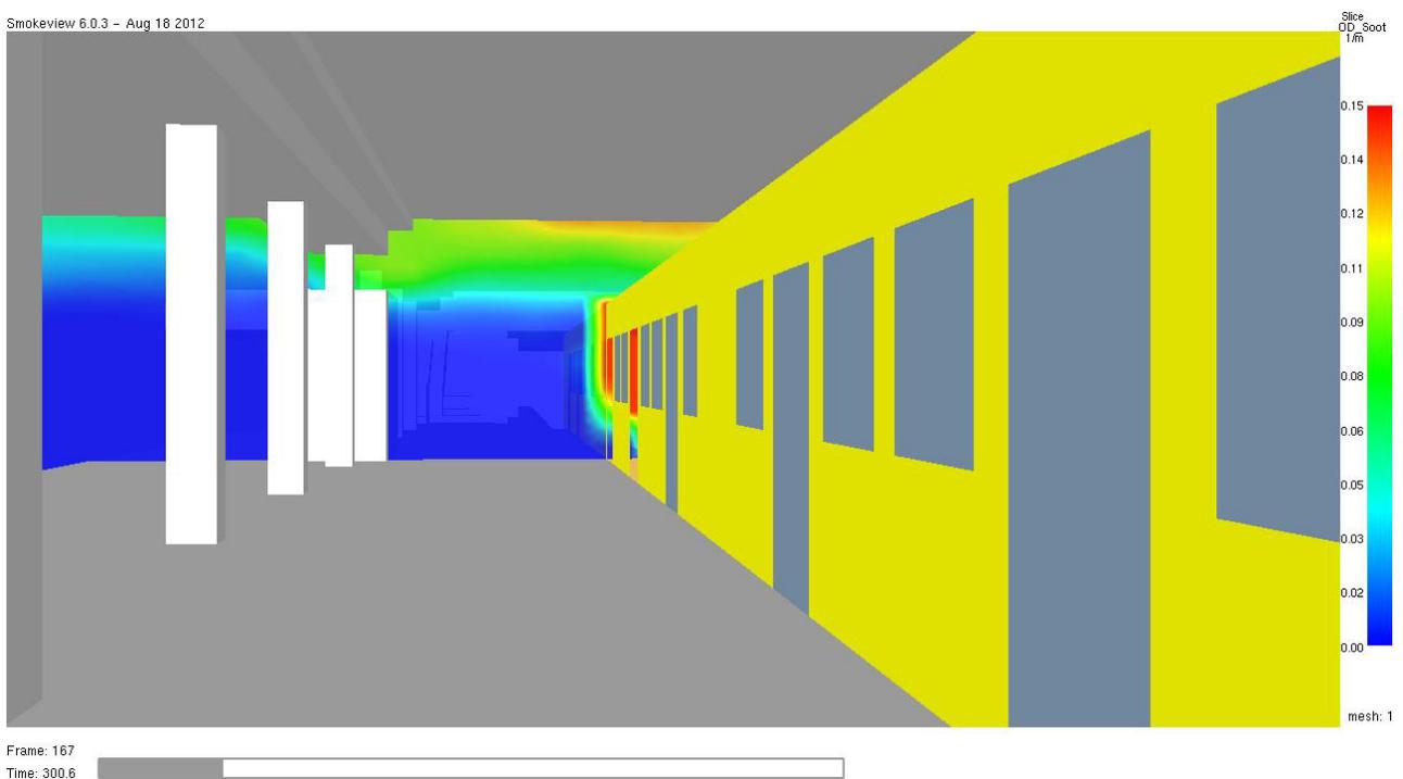
Abb. 35 **Optische Rauchdichte in 1/m** zum Zeitpunkt **t = 300 Sekunden** im Vertikalschnitt durch den Brandherd und Bahnhof. Das Schutzziel wird zu diesem Zeitpunkt vollumfänglich erfüllt.
