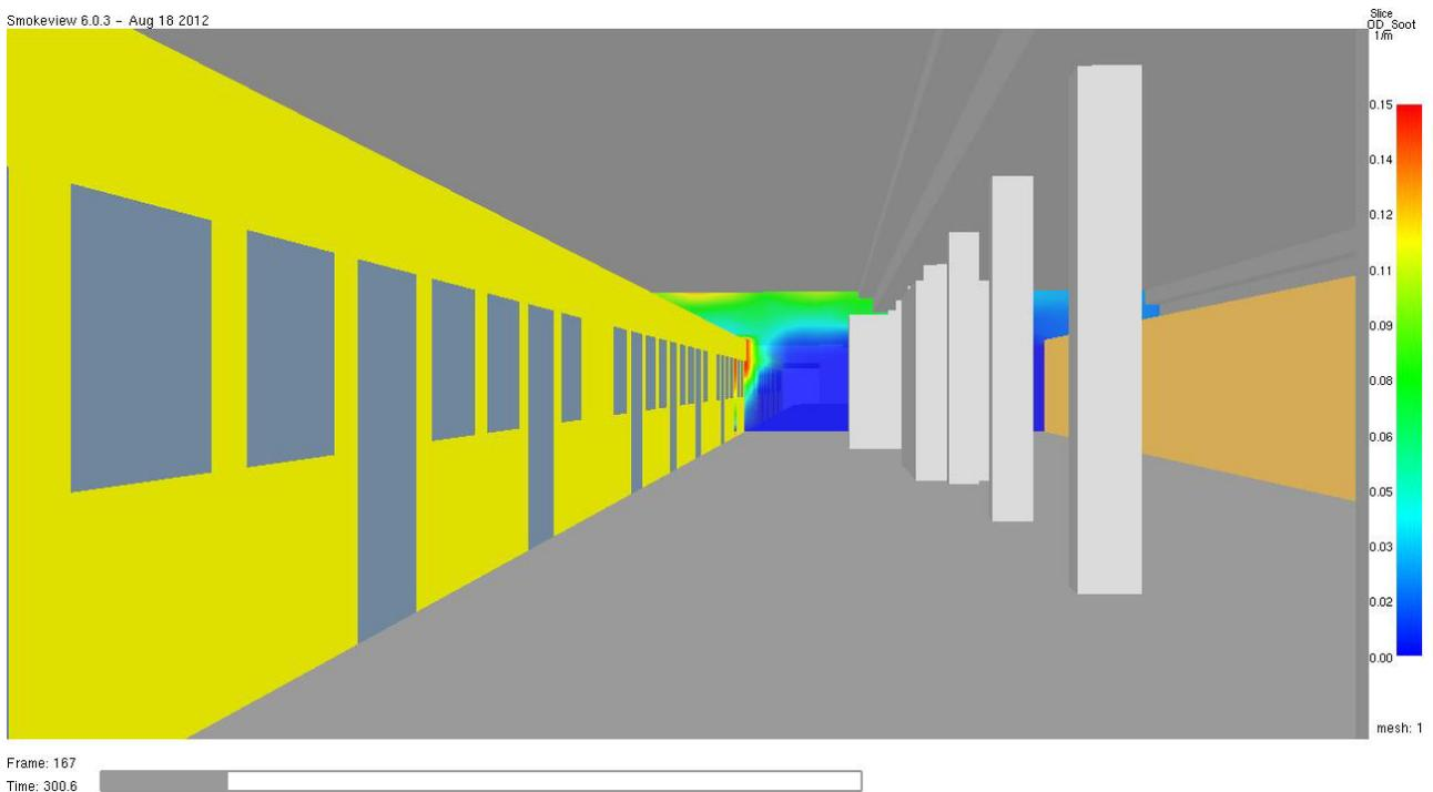
Abb. 20 **Optische Rauchdichte in 1/m** zum Zeitpunkt **t = 300 Sekunden** im Vertikalschnitt durch den Brandherd und Bahnhof. Das Schutzziel wird zu diesem Zeitpunkt vollumfänglich erfüllt.
