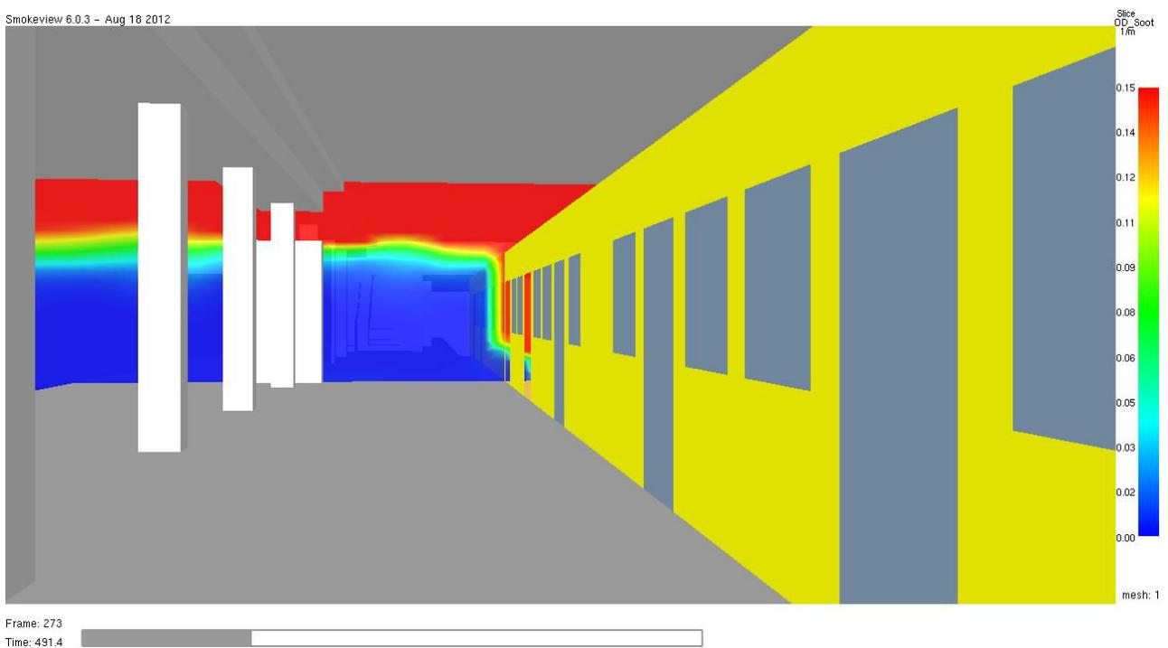
Abb. 41 **Optische Rauchdichte** in 1/m zum Zeitpunkt **t = 490 Sekunden** (8,2 Minuten = Evakuierungszeit) im Vertikalschnitt durch den Brandherd und Bahnhof. Das Schutzziel wird erfüllt.
