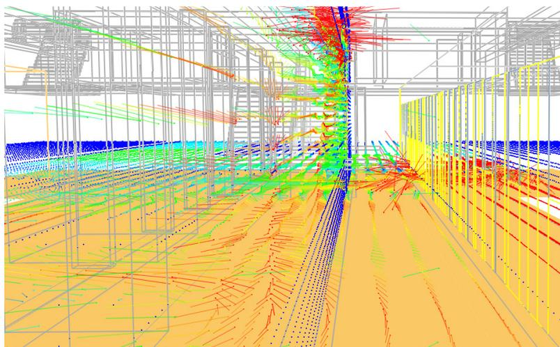
Abb. 10 Strömung in der Ebene des brennenden Triebwagens im Gleis
