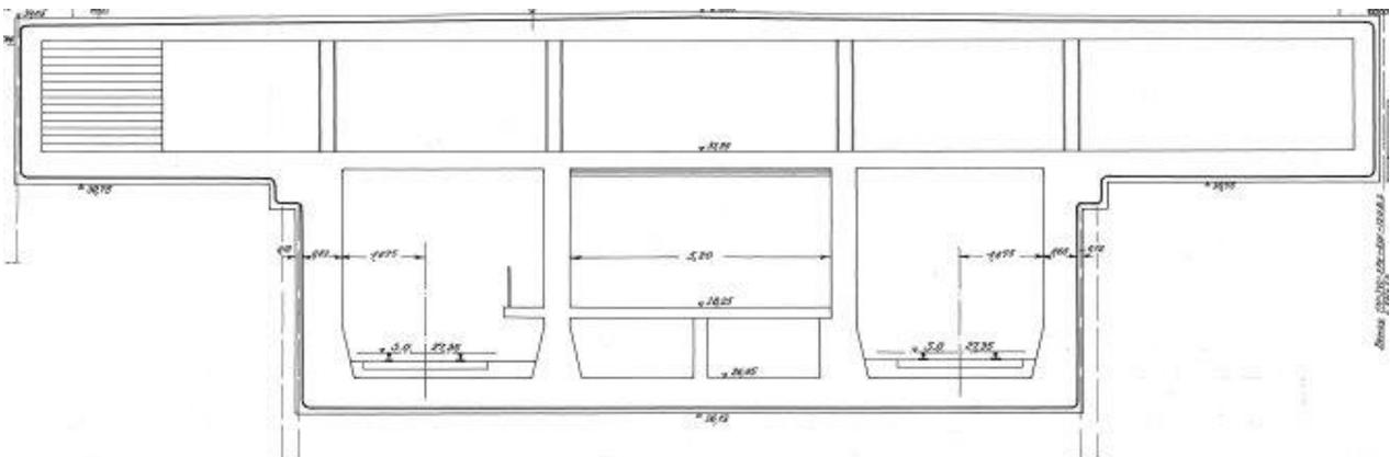
Abb. 9 Querschnitt durch den Bahnhof mit Verteilerebene
