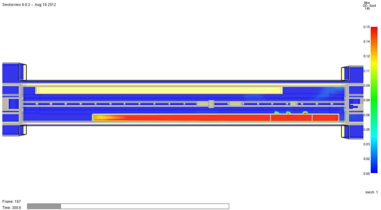
Abb. 32 **Optische Rauchdichte in 1/m** zum Zeitpunkt **t = 300 Sekunden** im Horizontalschnitt in 2,0 m Höhe über dem Fußboden des **Bahnsteigs**. Das Schutzziel wird zu diesem Zeitpunkt erfüllt.
