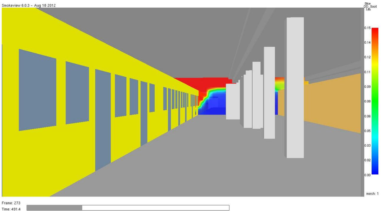
Abb. 26 **Optische Rauchdichte** in 1/m zum Zeitpunkt **t = 490 Sekunden** (8,2 Minuten = Evakuierungszeit) im Vertikalschnitt durch den Brandherd und Bahnhof. Das Schutzziel wird erfüllt.
