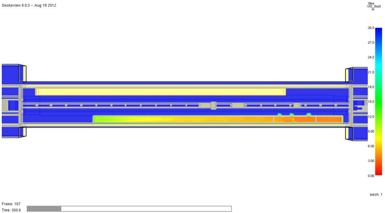
Abb. 36 **Erkennungsweite in m** zum Zeitpunkt **t = 300 Sekunden** im Horizontalschnitt in 2,0 m Höhe über dem Fußboden des **Bahnsteigs**. Das Schutzziel wird zu diesem Zeitpunkt erfüllt.
