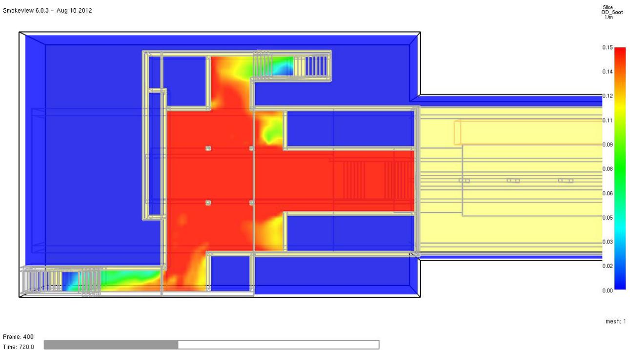
Abb. 30 **Optische Rauchdichte** in 1/m zum Zeitpunkt **t = 720 Sekunden** im Horizontalschnitt in 2,0 m Höhe über dem Fußboden der **Schalterhalle I**. Ab ca. diesem Zeitpunkt ist der größte Bereich der Schalterhalle verraucht. Der Zugänge zu den Ausgängen I/1 und I/2 sind noch nutzbar.
