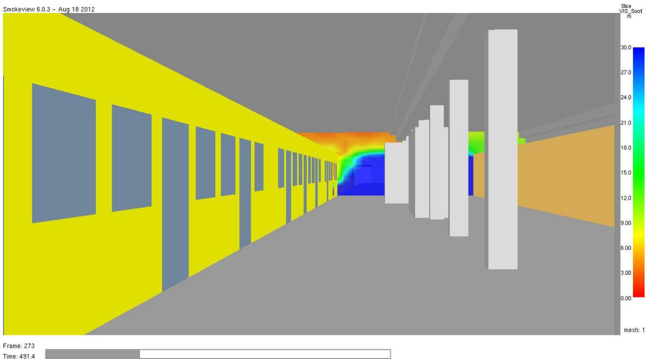
Abb. 28 **Erkennungsweite in m** zum Zeitpunkt **t = 490 Sekunden** (8,2 Minuten = Evakuierungszeit) im Vertikalschnitt durch den Brandherd und Bahnhof. Das Schutzziel wird erfüllt.
