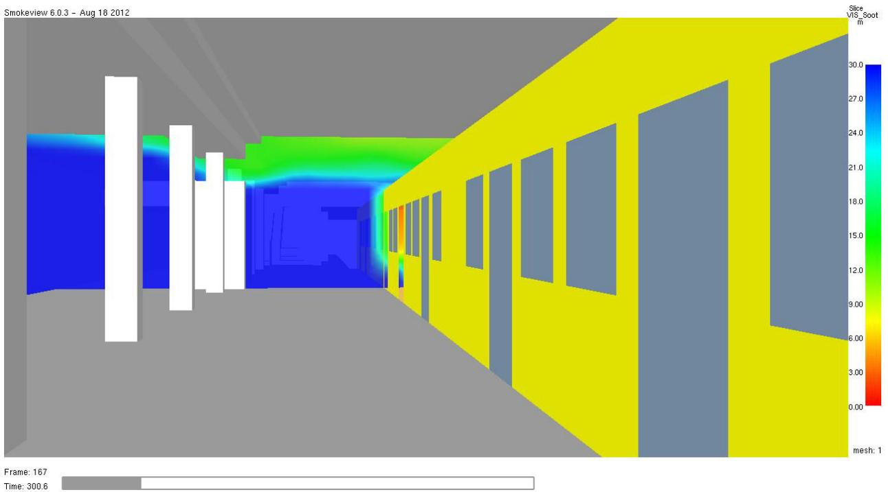
Abb. 37 **Erkennungsweite in m** zum Zeitpunkt **t = 300 Sekunden** im Vertikalschnitt durch den Brandherd und Bahnhof
