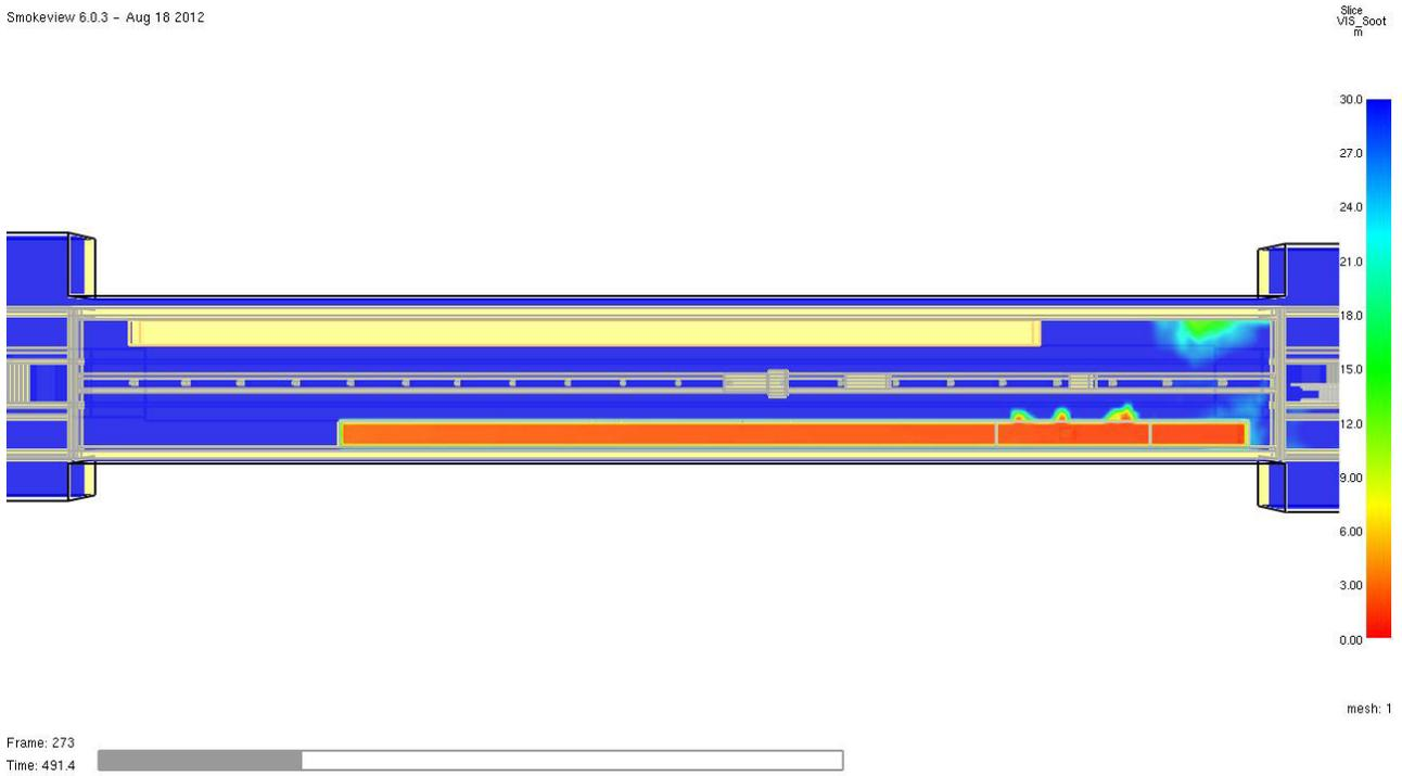
Abb. 42 **Erkennungsweite in m** zum Zeitpunkt **t = 490 Sekunden** (8,2 Minuten = Evakuierungszeit) im Horizontalschnitt in 2,0 m Höhe über dem Fußboden des **Bahnsteigs**. Das Schutzziel wird vollumfänglich erfüllt.
