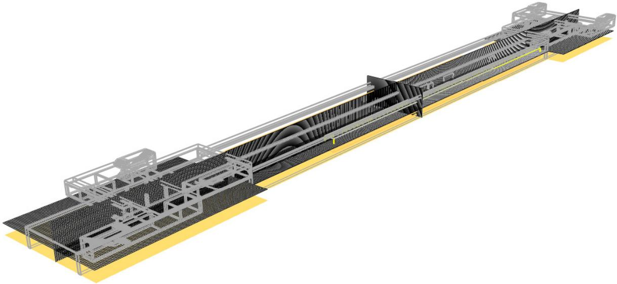
*Abb. 16 Verwendetes Rechengitter für die CFD-Simulation des U-Bahnhofes mit 2.903.040 Zellen*
