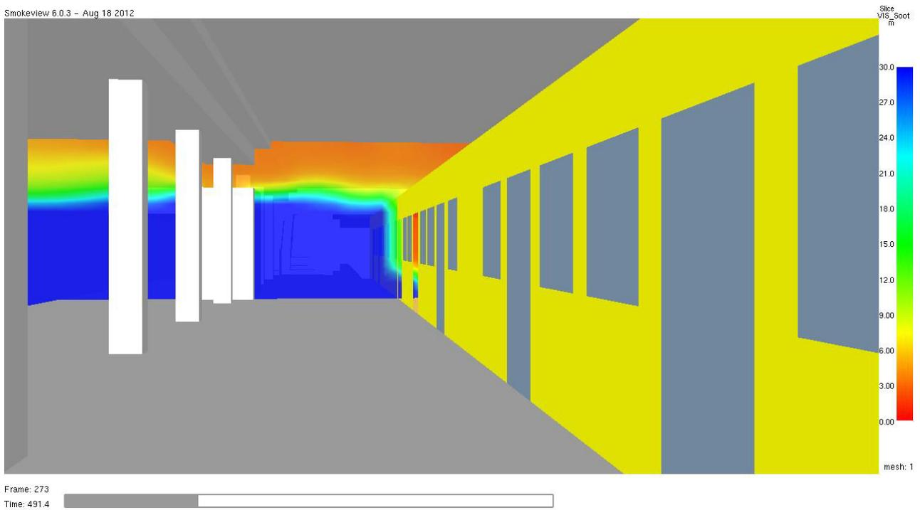
Abb. 43 **Erkennungsweite in m** zum Zeitpunkt **t = 490 Sekunden** (8,2 Minuten = Evakuierungszeit) im Vertikalschnitt durch den Brandherd und Bahnhof. Das Schutzziel wird erfüllt.
