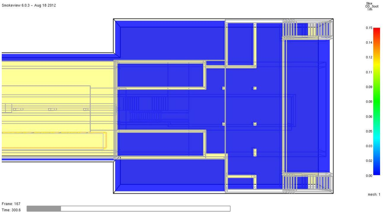
Abb. 19 **Optische Rauchdichte in 1/m** zum Zeitpunkt **t = 300 Sekunden** im Horizontalschnitt in 2,0 m Höhe über dem Fußboden der **Schalterhalle II**. Das Schutzziel wird zu diesem Zeitpunkt vollumfänglich erfüllt.
