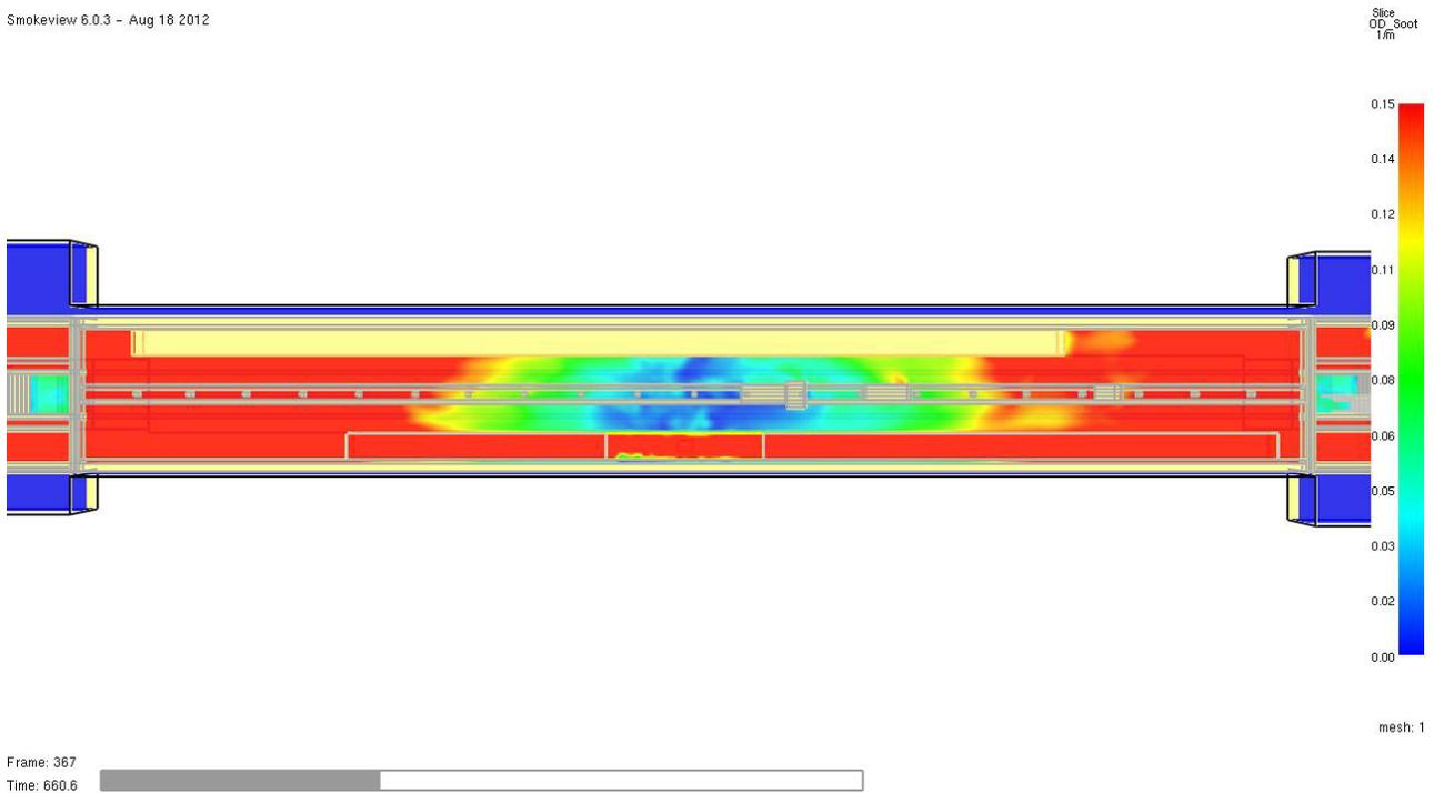
Abb. 29 **Optische Rauchdichte** in 1/m zum Zeitpunkt **t = 660 Sekunden** im Horizontalschnitt in 2,0 m Höhe über dem Fußboden des **Bahnsteigs**. Ab ca. diesem Zeitpunkt ist der Bahnsteig nicht mehr passierbar, da die Bereiche vor den Aufgängen in die Schalterhallen I und II verraucht sind.
