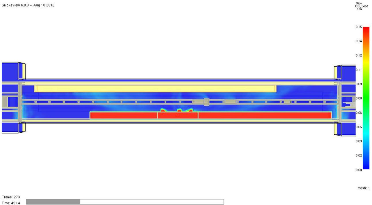
Abb. 23 **Optische Rauchdichte** in 1/m zum Zeitpunkt **t = 490 Sekunden** (8,2 Minuten = Evakuierungszeit) im Horizontalschnitt in 2,0 m Höhe über dem Fußboden des **Bahnsteigs**. Der Grenzwert von 0,15 1/m wird nicht erreicht. Das Schutzziel wird zu diesem Zeitpunkt vollumfänglich erfüllt.
