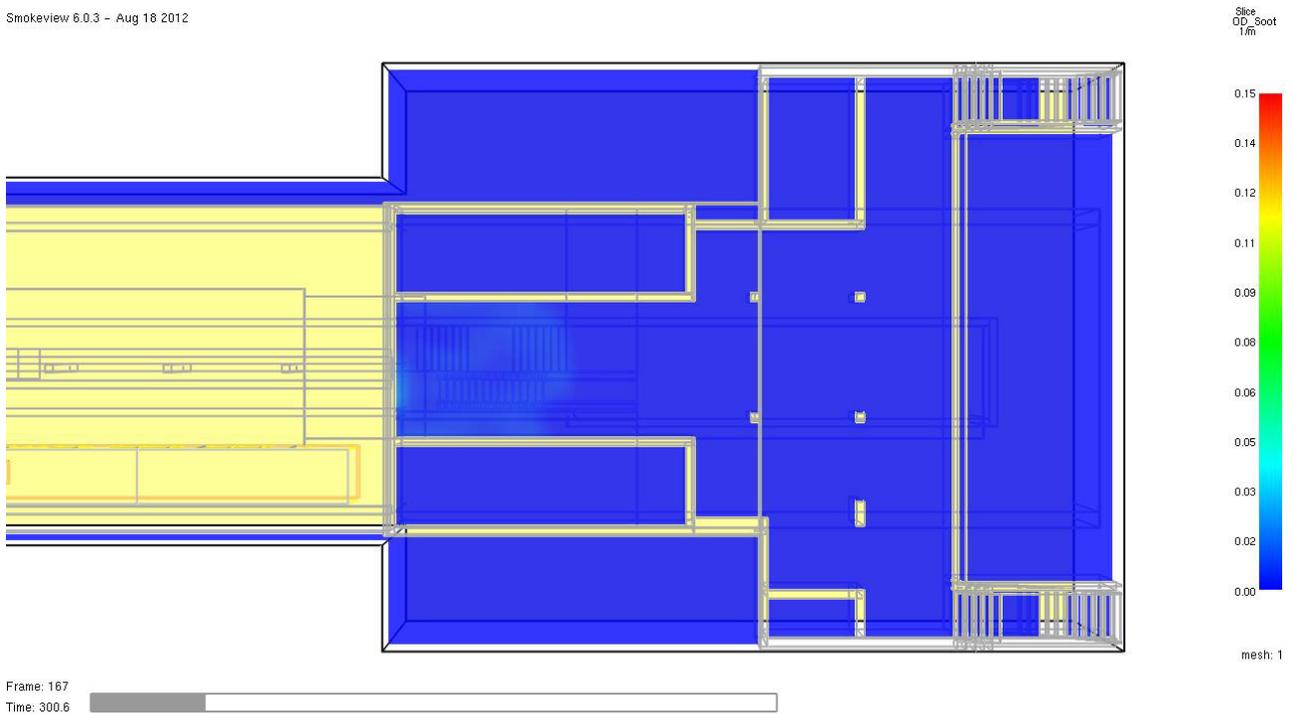
Abb. 34 **Optische Rauchdichte in 1/m** zum Zeitpunkt **t = 300 Sekunden** im Horizontalschnitt in 2,0 m Höhe über dem Fußboden der **Schalterhalle II**. Das Schutzziel wird zu diesem Zeitpunkt vollumfänglich erfüllt.
