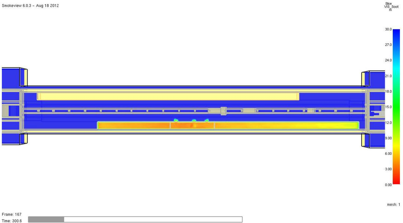
Abb. 21 **Erkennungsweite in m** zum Zeitpunkt **t = 300 Sekunden** im Horizontalschnitt in 2,0 m Höhe über dem Fußboden des **Bahnsteigs**. Das Schutzziel wird zu diesem Zeitpunkt erfüllt.
