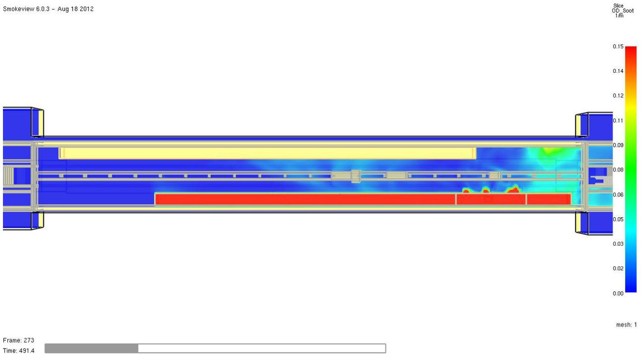
Abb. 38 **Optische Rauchdichte** in 1/m zum Zeitpunkt **t = 490 Sekunden** (8,2 Minuten = Evakuierungszeit) im Horizontalschnitt in 2,0 m Höhe über dem Fußboden des **Bahnsteigs**. Der Grenzwert von 0,15 1/m wird nicht erreicht. Das Schutzziel wird zu diesem Zeitpunkt erfüllt.
