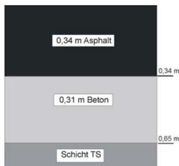
Erkundet wurde ein Aufbau aus 0,34 m Asphalt und 0,31 m Beton. Im Liegenden der gebundenen Schichten ist mit Schicht TS eine Tragschicht aus schwach schluffigem, sandigem Kies mit Schotter (Bodengruppe [GU]) vorhanden.
