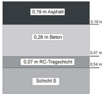
In der Karl-Ziegler-Straße wurde ein Aufbau aus 0,19 m Asphalt, 0,28 m Beton und 0,07 m RC-Tragschicht angetroffen. Im Liegenden der RC-Tragschicht ist mit Schicht S Talsand vorhanden.
